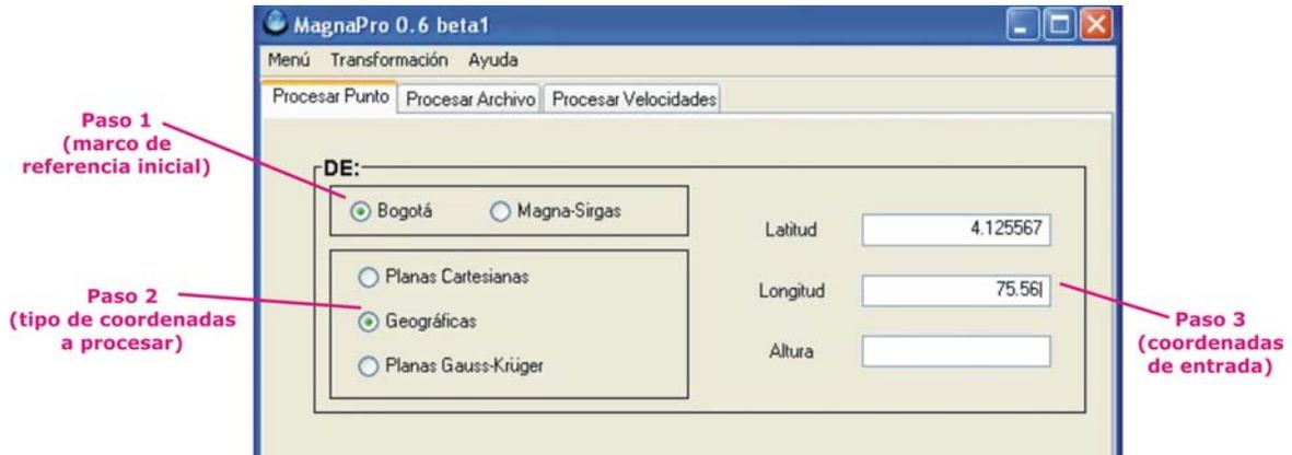
Figura 1. Datos de entrada en el procesamiento individual de puntos
