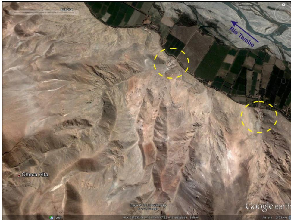
Figura 9. Imagen satelital del Google Earth, sector de Santa María, se resalta en círculos de color amarillo las áreas que pueden ser afectadas por flujos de detritos, en la margen izquierda del río Tambo (tomado por Nuñez, 2010).
