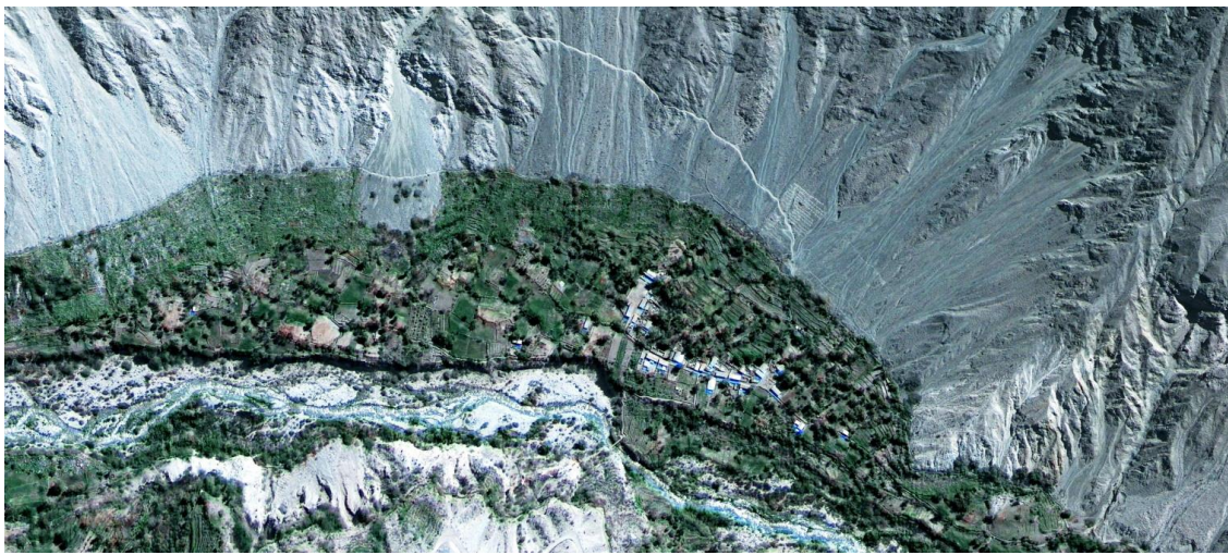
Figura 12. Se observa procesos de erosión fluvial que podría afectar viviendas y tierras de cultivo del sector Yachanguillo. Además, se observa ocurrencias de flujos de detritos. Imagen Google Earth Pro.
