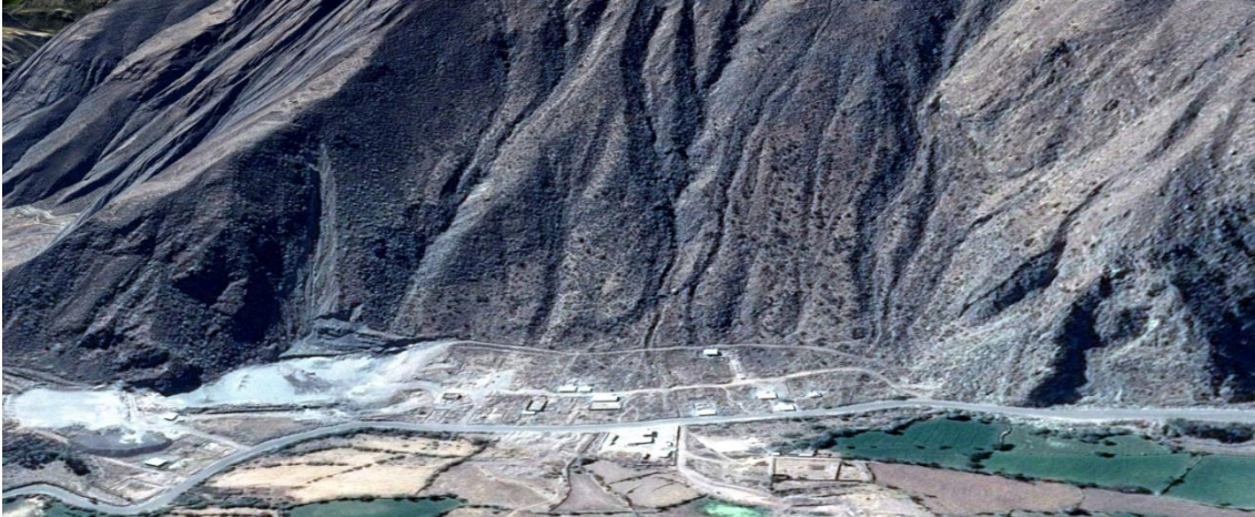
Figura 16. En sector de Chacaylla, se observan viviendas sobre antiguos depósitos de flujos de detritos. Con presencia de erosión en cárcava. Imagen Google Earth (Medina et al., inédito).
