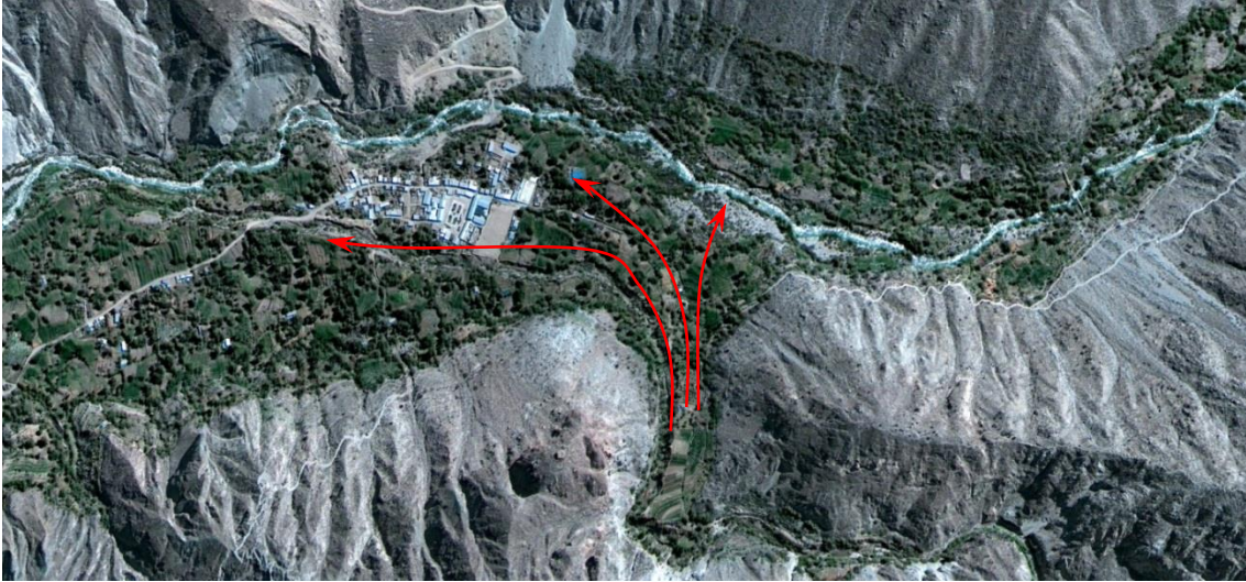
Figura 13. Se observa a la población de Chichas asentada sobre depósitos de flujos antiguos provenientes de la quebrada Añavilca. Imagen Google Earth.
