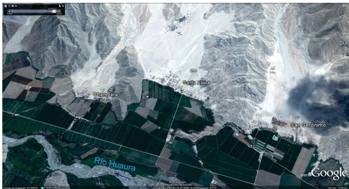
Figura 8. Zona de flujos de detritos de grandes dimensiones excepcionales, algunas viviendas de los poblados Chambará, Santa Elvira y San Gerónimo se encuentra en pleno cauce de las quebradas Lloclla, Santa Elvira y Desamparado respectivamente, en la margen derecha del río Huaura.
