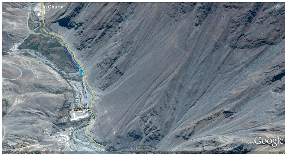
Figura 7. Erosión fluvial en la margen derecha del río Huaura y derrumbes en forma de canchales de detritos en el cerro Antaycoto, talud superior de carretera Huaura-Churín en la margen izquierda de río Huaura, en el sector Mirahuay.
