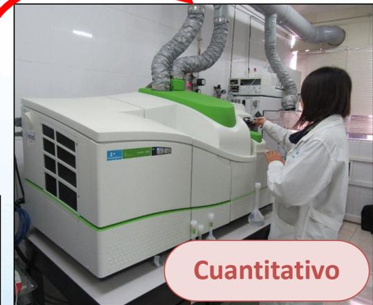
Espectrómetro de acoplamiento inductivo con detector masa (ICP-MS)
