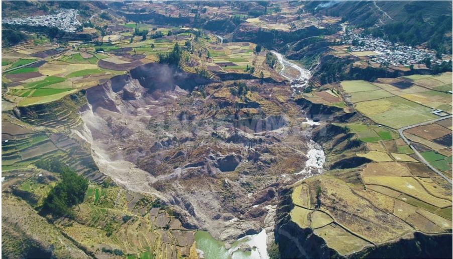
*El tipo de suelo está compuesto por capas de material coluvial intercalado con capas de arenas y limo-arcilla ( [Ver video](#) )*
