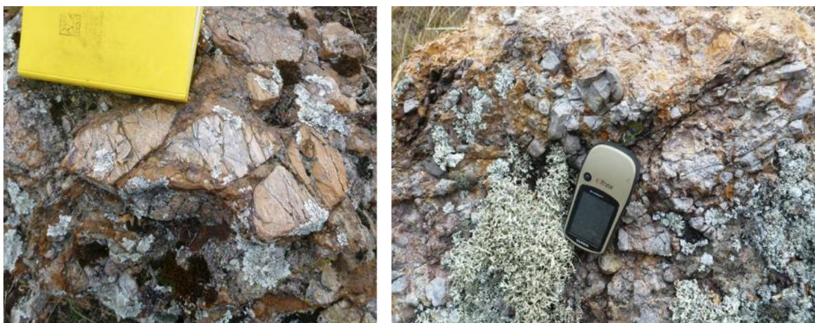
Foto 5.12 Detalle del cuerpo de brecha freática con matriz soportada tipo polvo de roca cuyo cemento es sílice arcillas también se registra presencia de carbonatos siderita y smithsonita.
