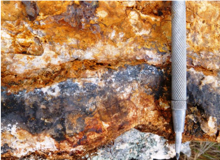
Foto 5.4 Detalle del lithocap silíceo con textura bandeada con venillas y tinciones de óxidos
