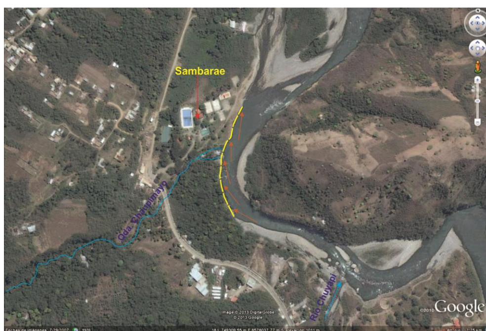
Figura 10: Imagen Google Earth del balneario de Sanbarae, se ha indicado la zona de erosión, la quebrada Chaupimayo (Qda. Sambarae) y la ubicación de los enrocados (líneas amarillas entrecortadas).
