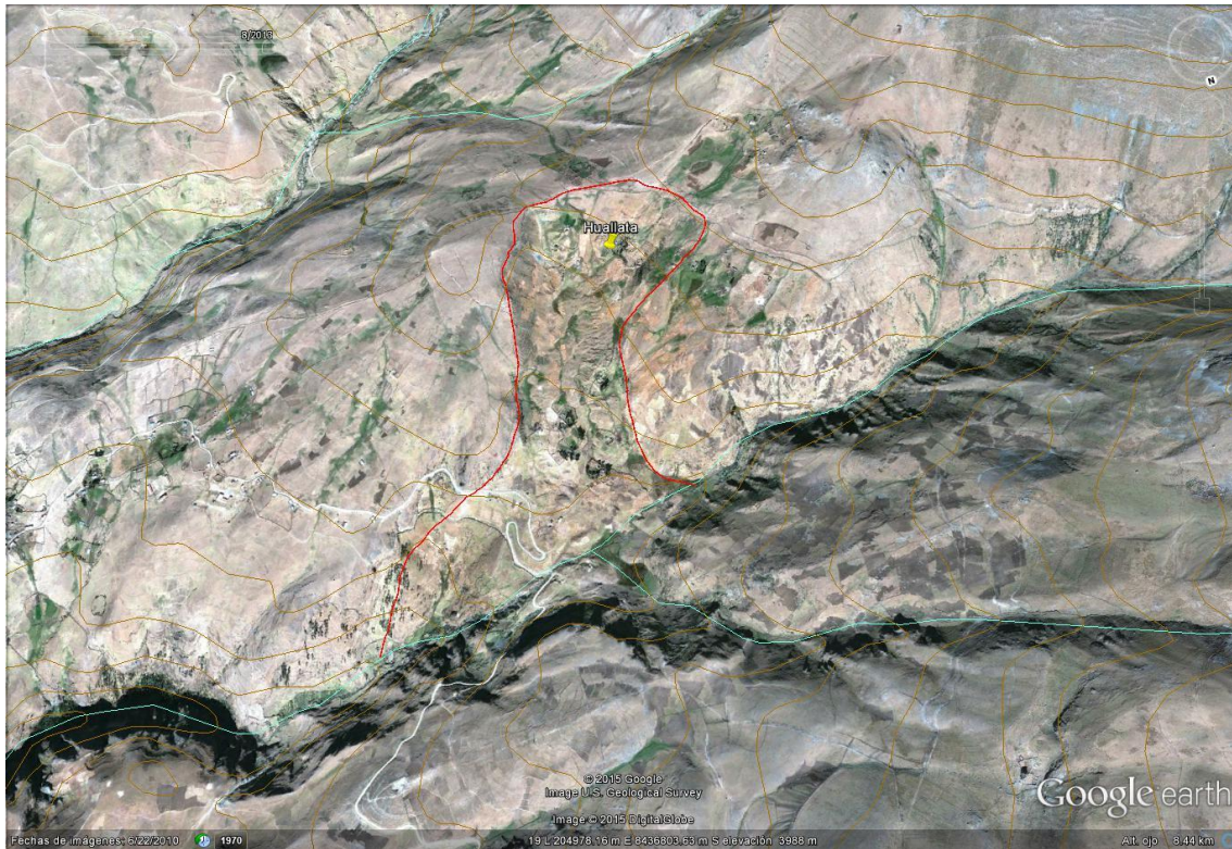
Figura 16: Imagen Google Earth con vista al suroeste donde se han delineado con línea roja el limite aproximado del flujo de tierra.
