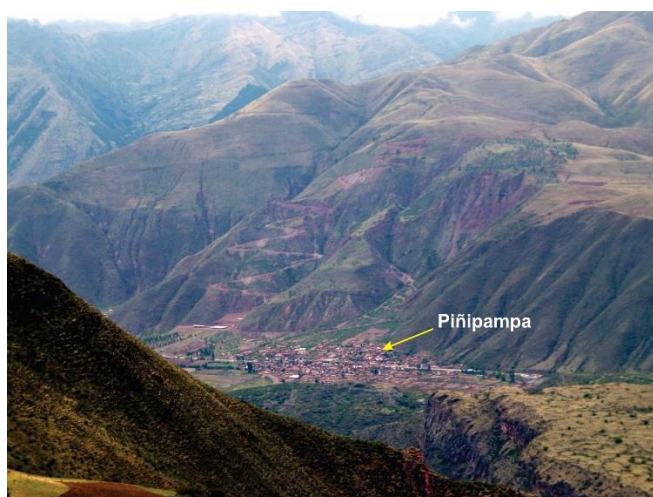
Foto 69: Poblado de Piñipampa asentado en el cono de deyección de quebrada de corto recorrido, nuevos flujos pueden afectar al poblado.
