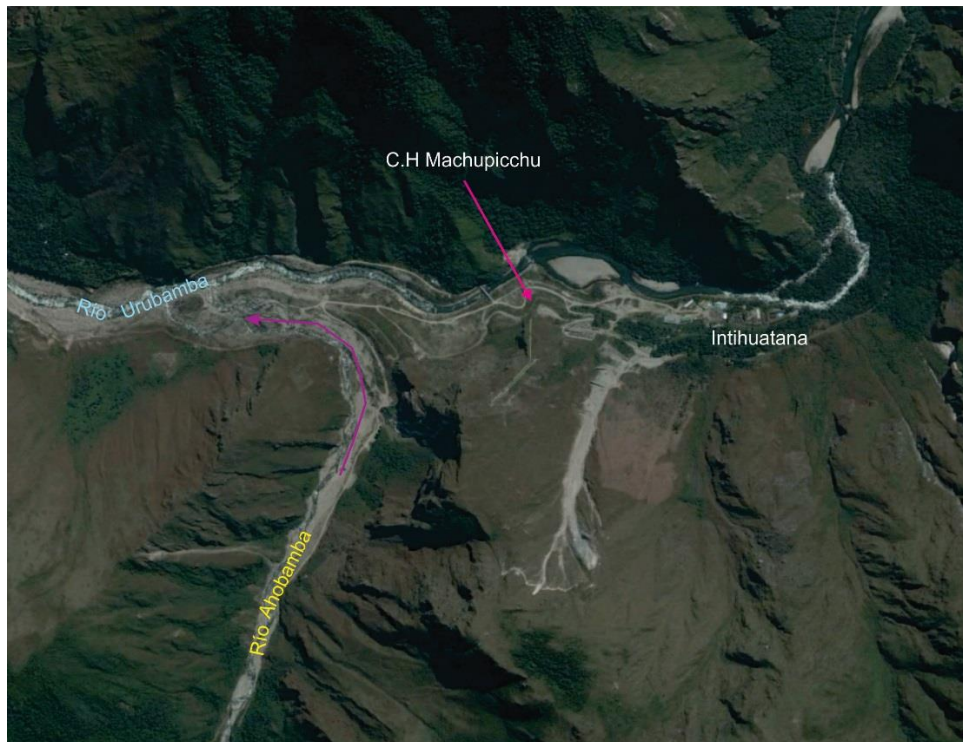
Figura 7: Vista del río Urubamba donde se encuentra la C.H de Machupicchu, también se puede observar el cauce del río Ahobamba, por donde discurrió un aluvión que represo el río Urubamba y provoco daños en la central hidroeléctrica.
