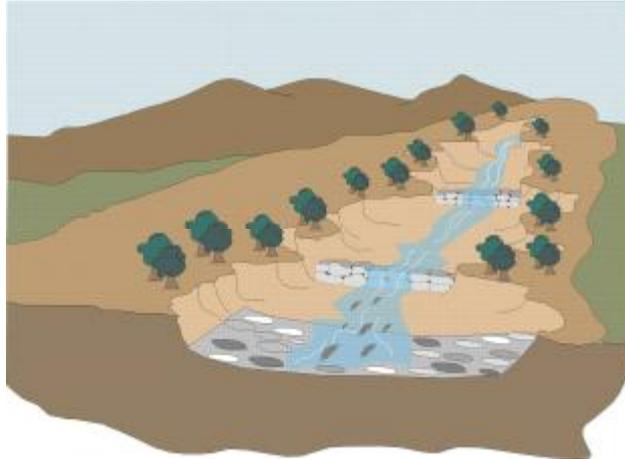
Figura 12.5. Presas de sedimentación escalonada para controlar la fuerza destructiva de los huaycos
