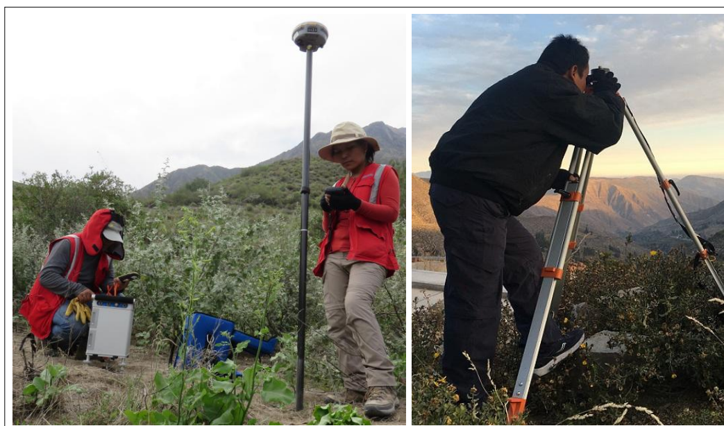
Figura 74. Recolección de datos de gravedad y GPSD (imagen izquierda), nivelación de la base del GPSD en la zona de Ullucan (imagen derecha).
