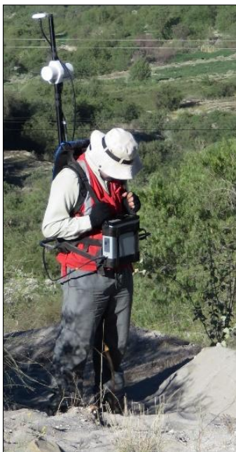
Figura 70. Personal geofísico realizando la recolección de datos de la intensidad del campo magnético total en el sector de Ullucan, se utilizó dos magnetómetros GEM System GSW-19W Overhauser, un móvil y una base.
