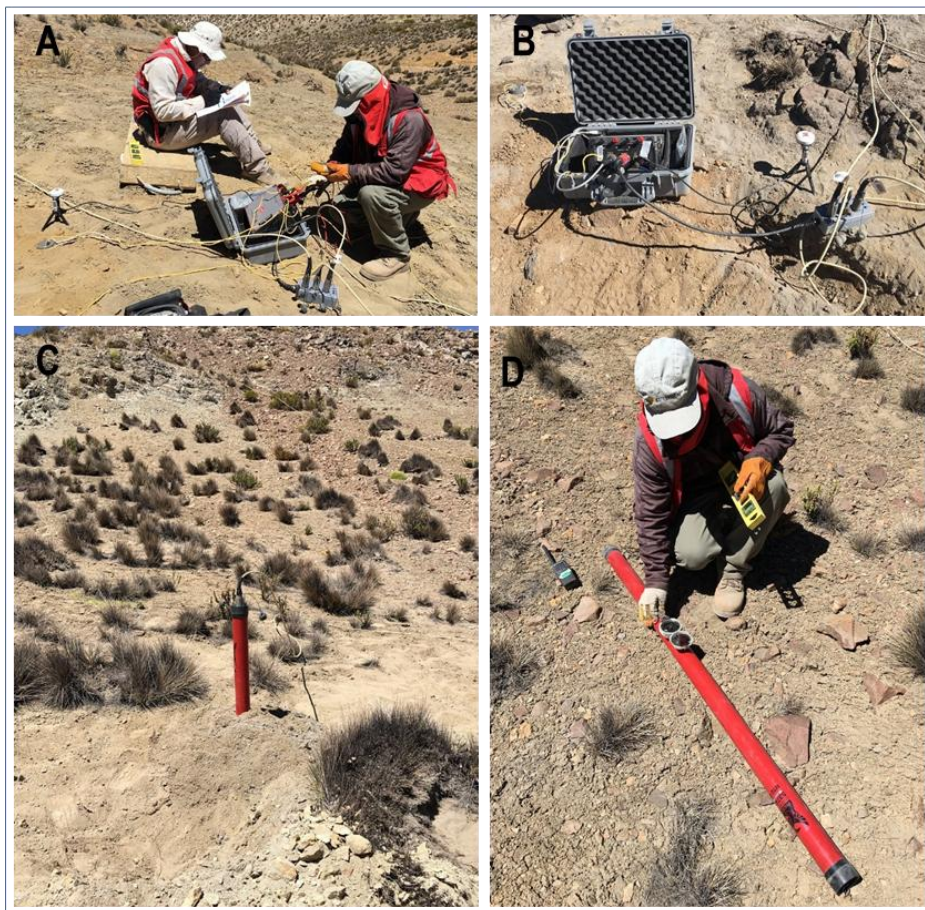
Figura 86. Instalación del MTU5A en terreno, en A) personal geofísico realizando la preparación y toma de datos iniciales de los instrumentos MTU5A, GPSD. B) instrumento de MT ya instalado operativo para iniciar el registro de datos. C) bobina vertical instalada y conectada al instrumento MT y D) personal iniciando la preparación de la instalación de las bobinas horizontales para medir el campo magnético horizontal (Simpson, 2005).
