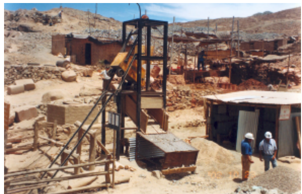
Vista del castillo del winche de izaje de mineral (mina Santa Filomena).
