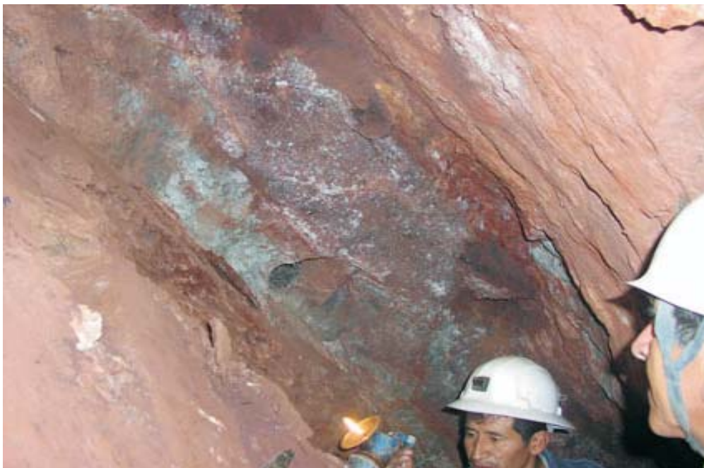
Foto N° 23 Vista tomada en interior mina de veta Francia de rumbo N54°O y buzamiento 76° NE de 0,50 m de potencia, se observan hematitas, crisocola y limonita. Actualmente en explotación por una empresa formal.
