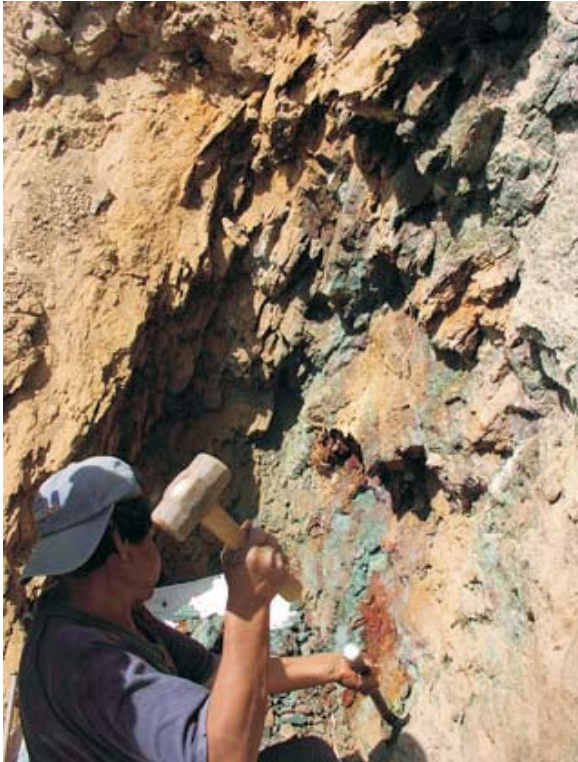
Foto N°14 Estructura subvertical mineralizada donde el minero artesanal selecciona el material económico.
