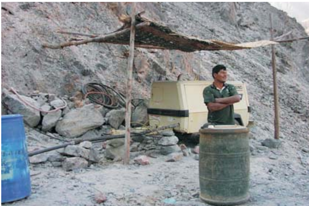
Foto N° 5 Compresora de un martillo instalada para operaciones en la mina Rey Felipe cerro huatiapilla-Chuquibamba
