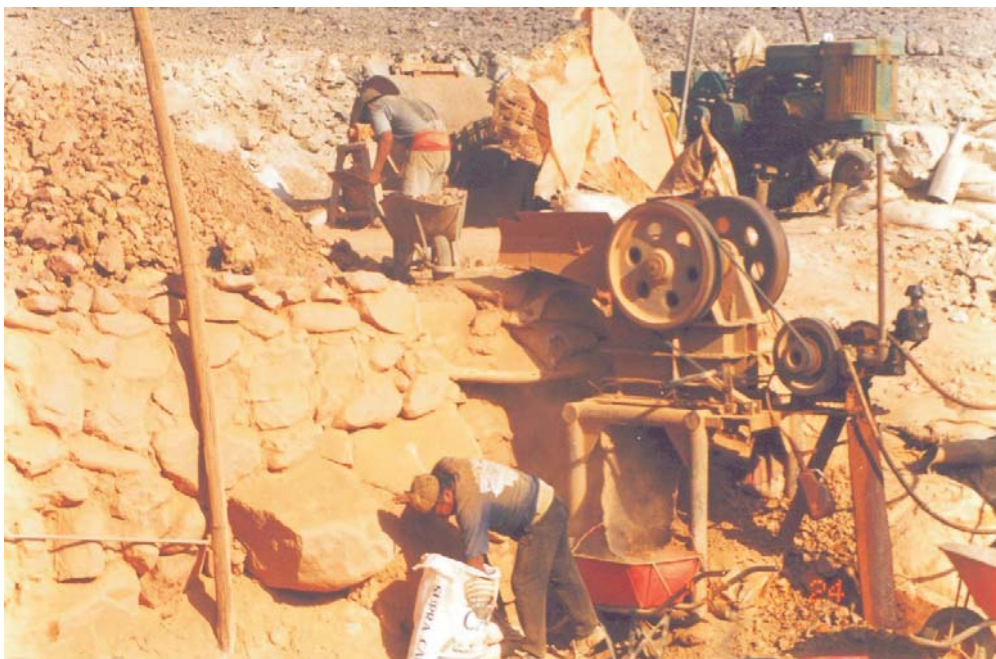
Foto N° 35 Chancadora de quijadas para la trituración de mineral de mina. Mina Paraíso Tulin.
