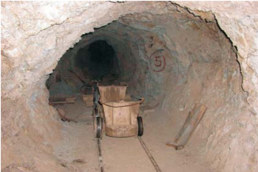
Foto N°11 Carro Minero sobre rieles para extracción de mineral Mina Orión Chala
