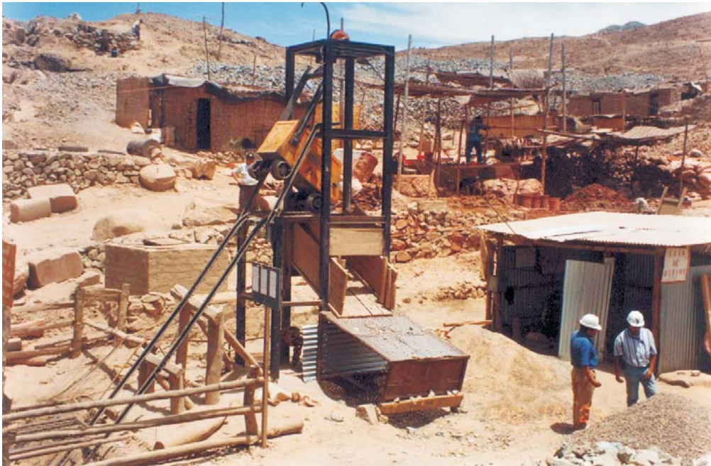
Foto N° 8 El transporte del mineral desde la mina a la planta de beneficio a través de skip motorizado. Mina Santa Filomena Jaquí.
