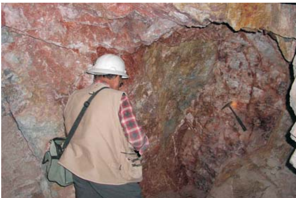
Foto N° 33 Veta principal Gloria con cuarzo y oro, emplazada en rocas metamórficas, con rumbo N35°O, buzamiento 85° NE y potencia 1 m.
