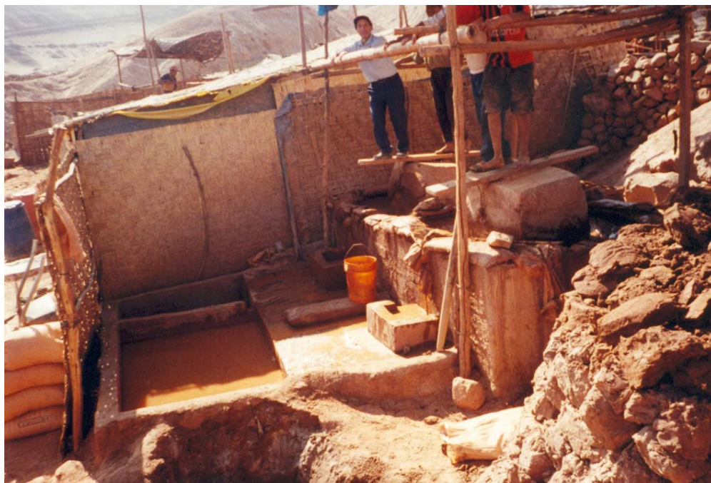
Foto N° 37 Sistema quimbalete con rebose que posibilita la pérdida de mercurio. Mina Eugenia
