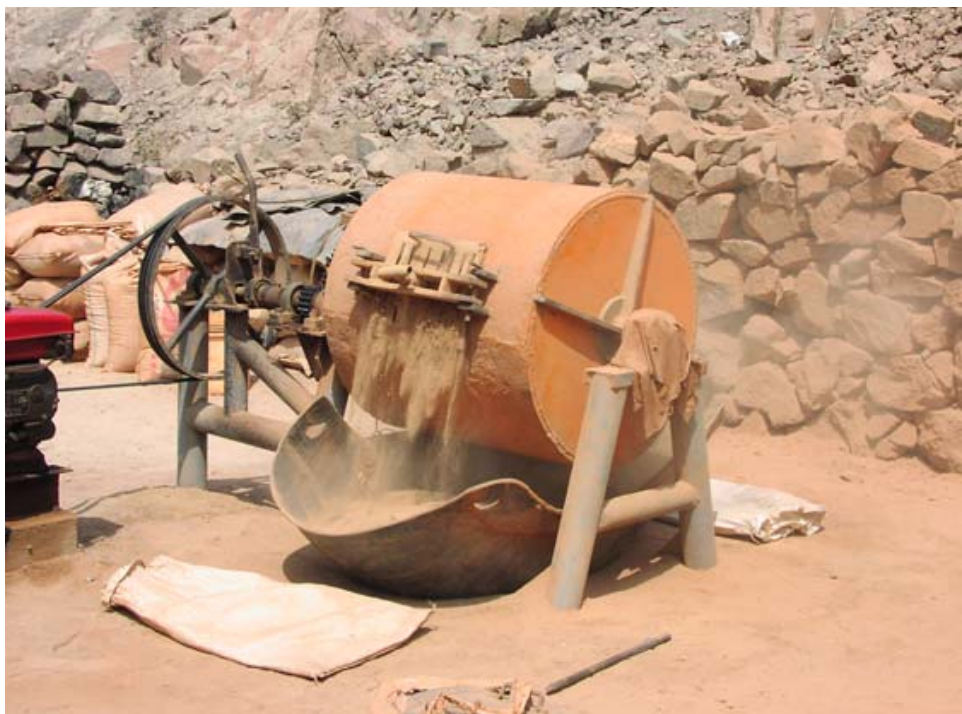
Foto N° 36 Molienda por tandas en seco, usando molino de bolas para proceso de amalgamación. Mina Chaparral – Atico.
