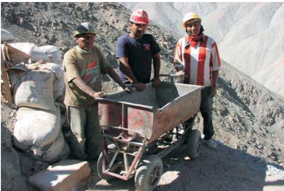
Foto N° 9 Carros mineros para transporte de mineral sobre ruedas neumáticas. Mina Cuatro Horas Cháparra
