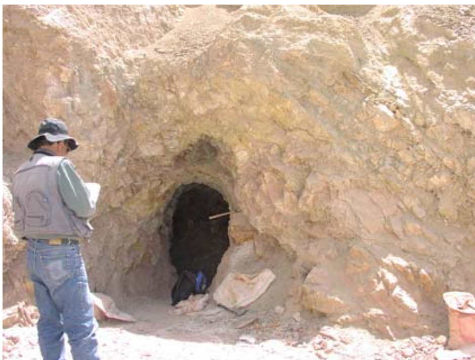
Foto N° 30 Mina actualmente reactivada por mineros artesanales. La veta principal tiene una potencia de 0,55 m con leyes alta de oro y malaquita en ganga de cuarzo.
