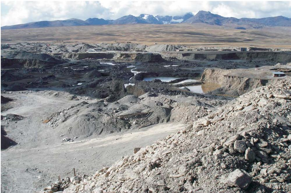
**Foto N° 29** En la zona de Ananea se observan las lagunas artificiales realizadas por los mineros para el lavado de concentrado con mercurio.
