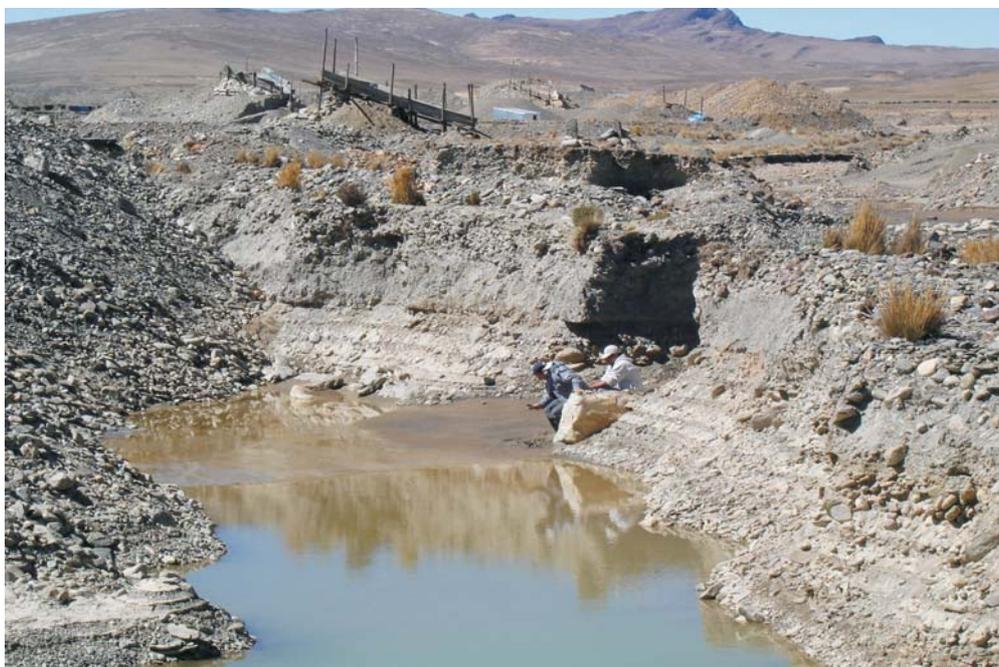
**Foto N° 10** Espejo de agua originado por las operaciones mineras: Muestreo de sedimentos superficiales en materiales alterados.
