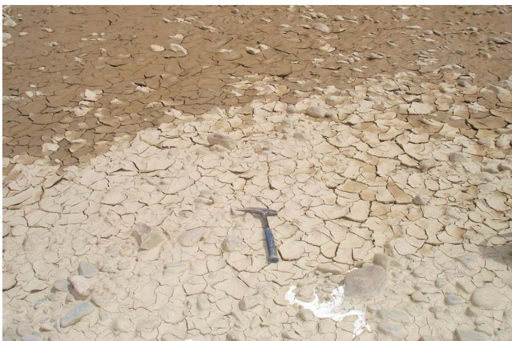
**Foto N°20** Grietas de desecación típicas de la presencia de limos
