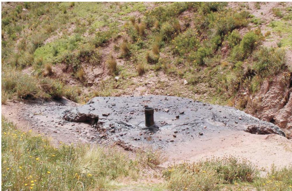
**Foto N° 12** Perforación de pozo para petróleo sin mayor protección y con constante flujo, en la zona de Huancané.
