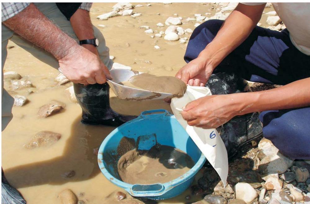
**Foto N°18** Muestreo de sedimentos: proceso de clasificación y disposición en bolsas microporosas.
