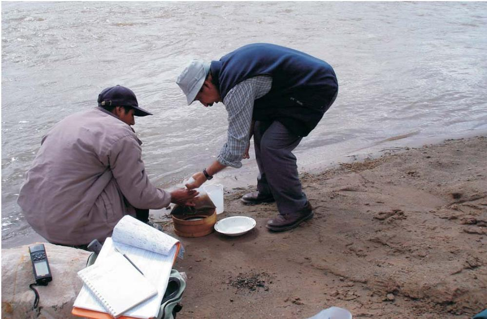
**Foto N° 17** Procedimiento del muestreo de sedimentos: en una distancia de 20 a 30 m se va seleccionando la muestra, utilizando la malla 30.
