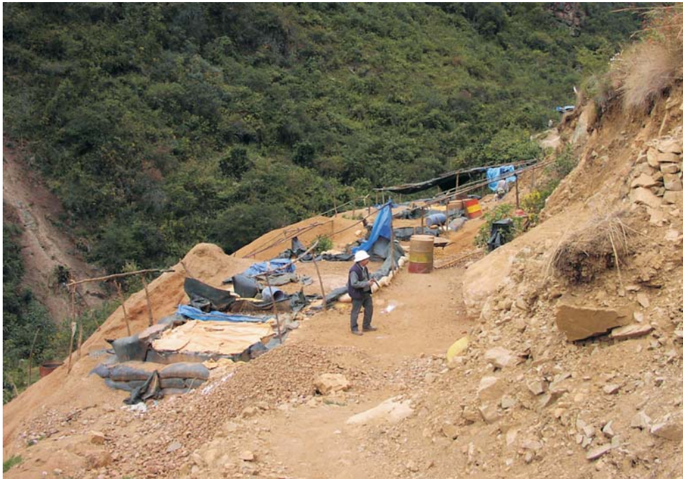
Fotos 39 Preparación de plataformas para depositar pilas de material aurífero para lixiviación, en zonas que vulneran el medio ambiente
