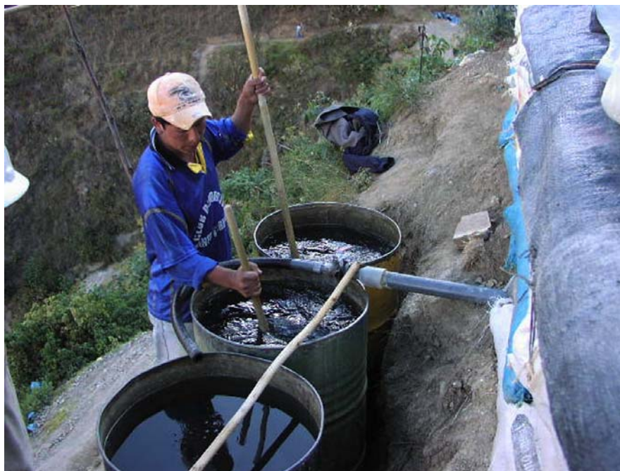
Foto 41 Sistema de agitación y precipitado de solución enriquecida
