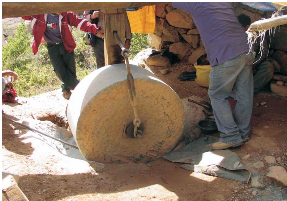
Foto 10 Se muestra el sistema molinete, usado principalmente para leyes elevadas, garantiza la velocidad de retorno
