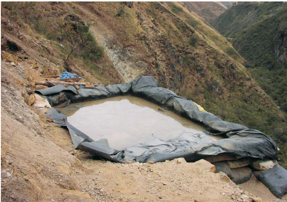
Foto 40 Distribución de solución de cianuro por inundación en pilas de dimensiones reducidas
