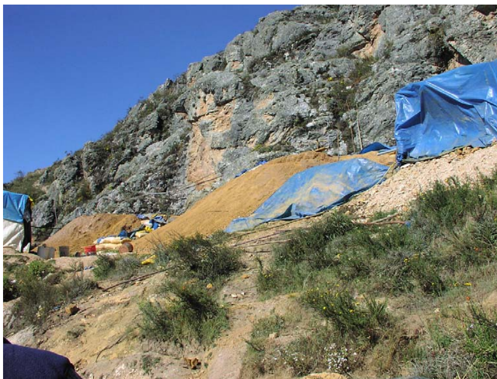
Foto 36 Canchas de mineral molido preparado para las pilas
