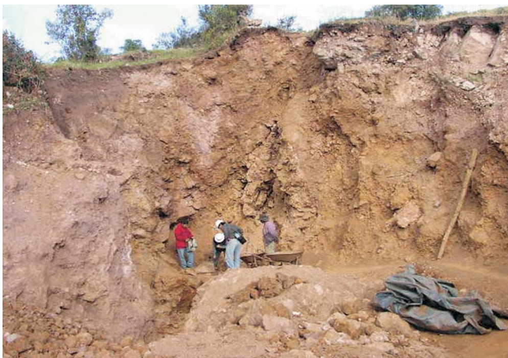
Foto 28 Desarrollo de operaciones en material diseminado sin control de estabilidad - Mina Quisuar, Laguna Seca (Chillia La Libertad).
