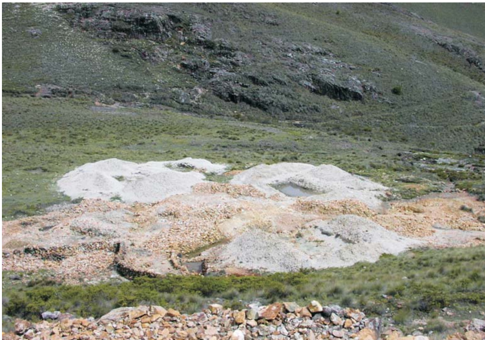
Foto 16 Mina Cleopatra, ubicada en Hualgayoc, explotada a tajo abierto, tiene evidencias de aguas ácidas provenientes de la lixiviación de pirita. Afloran rocas volcánicas intensamente alteradas a cuarzo-sericita de la Fm. Pariatambo del Cretáceo superior.
