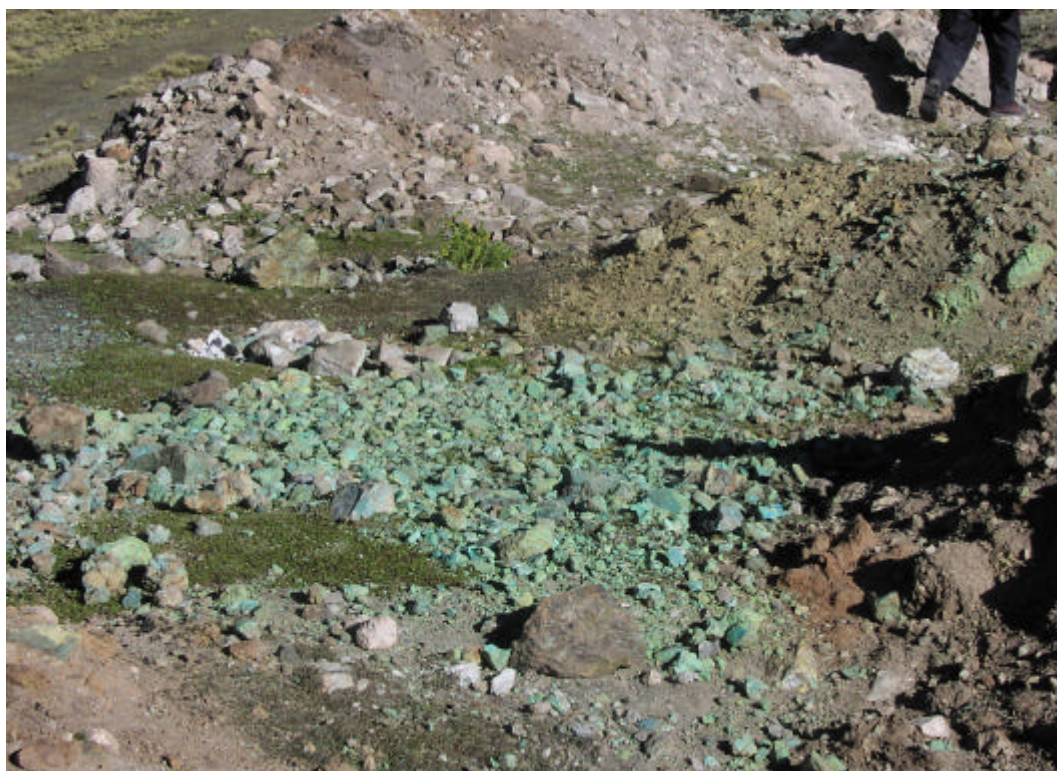
Foto 28.- Zona de disposición de mineral oxidado de cobre con leyes de 6,5% - Kiscancha.
