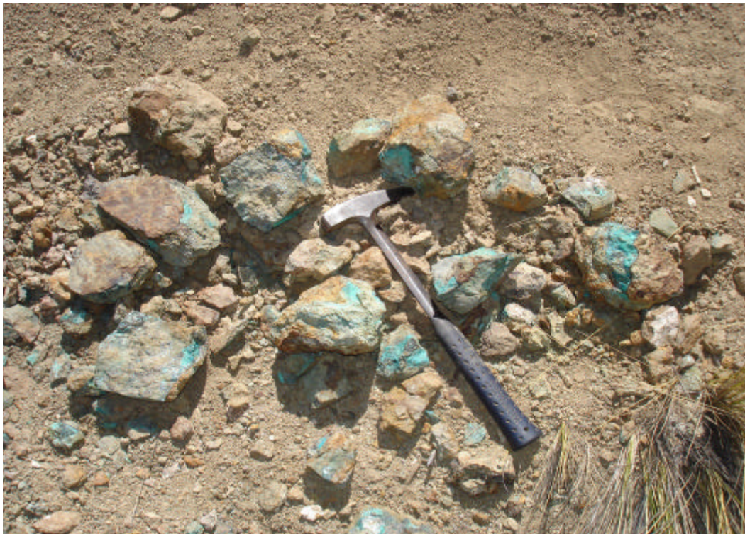
Foto 45.- Cancha de mineral de cobre dispuesto para su clasificación - Siete Amores.
