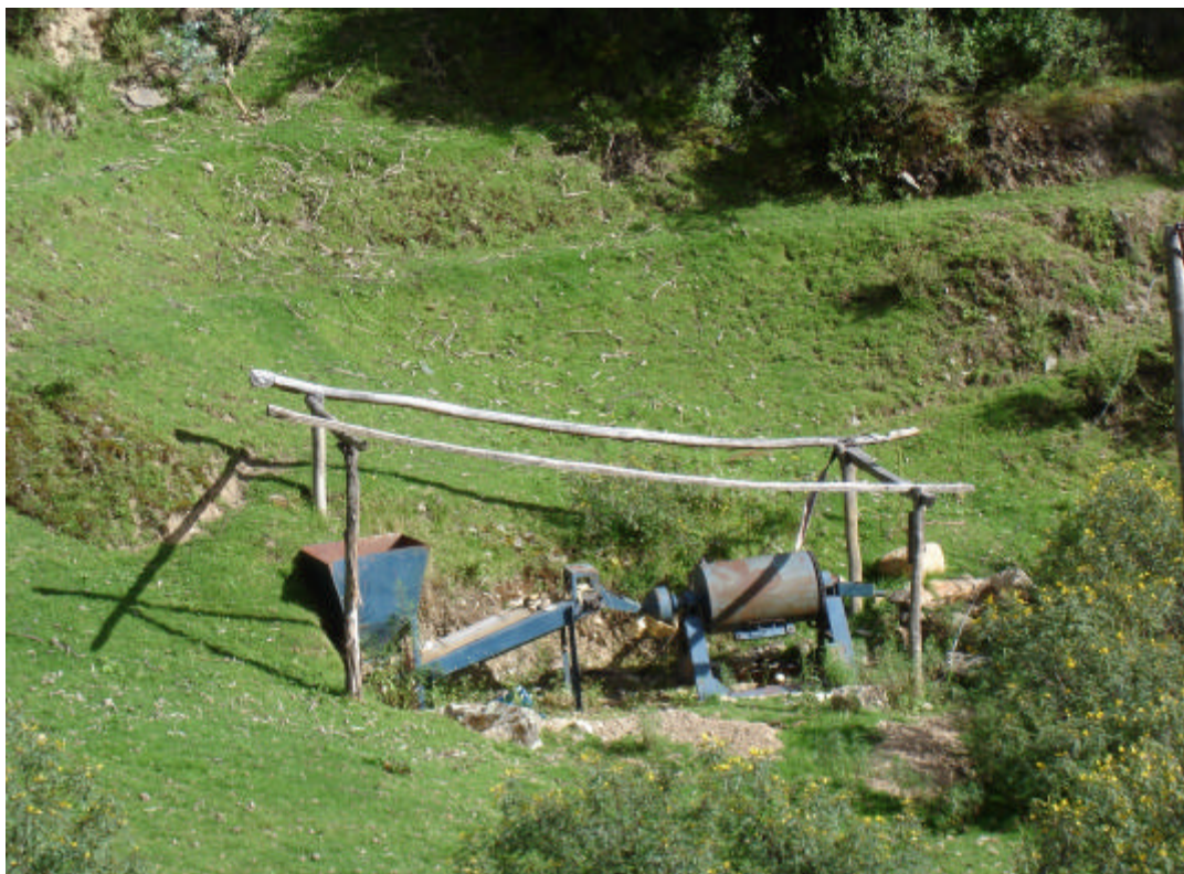
Foto 2.- Pequeña planta de recuperación de mineral por el método gravimétrico y de sistema continuo, con capacidad de 8 toneladas métricas por día - Pachaconas.
