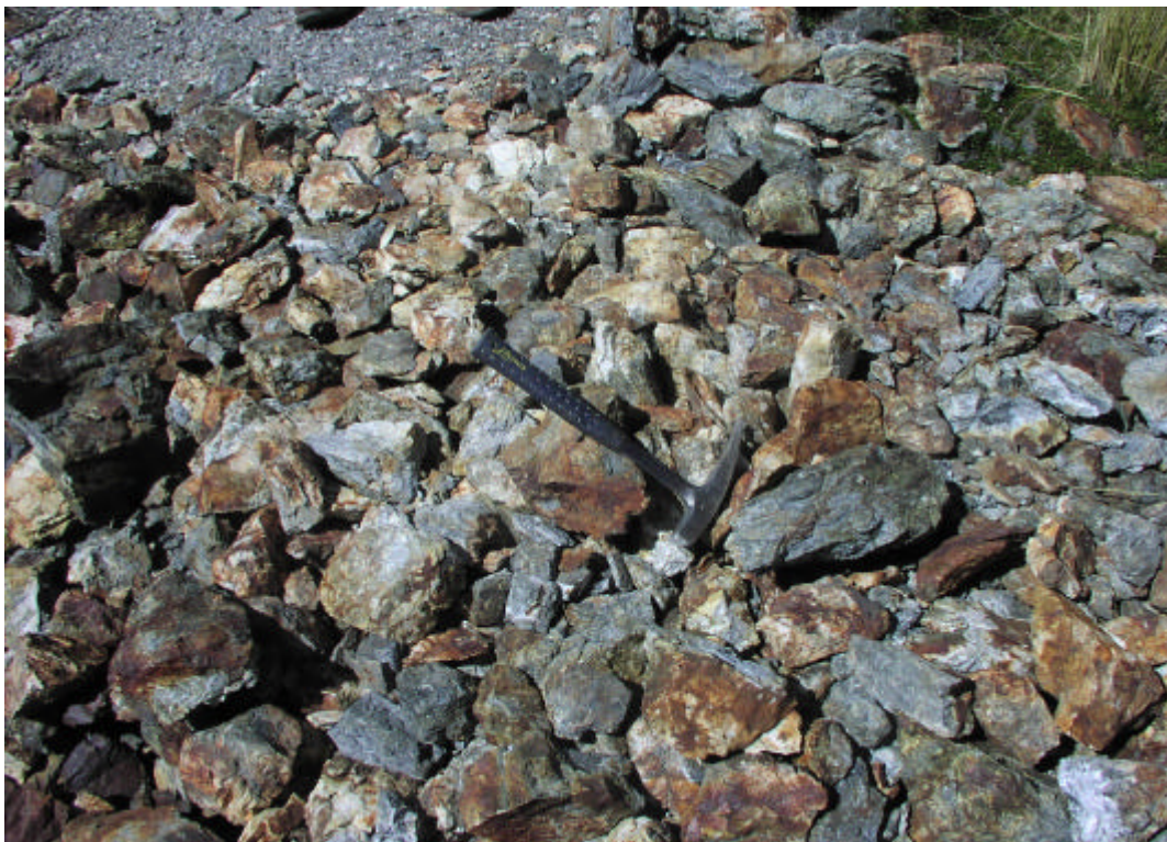
Foto 23.- Mineral de sulfuros de cobre dispuesto en zona de pallaqueo - Canta - Canta.
