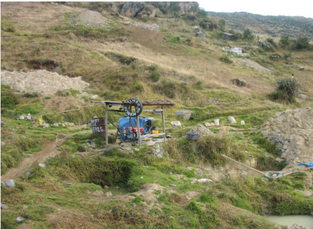
Foto 31.- Molino de bolas junto con generador junto a los socavones en operación - Lorocani.
