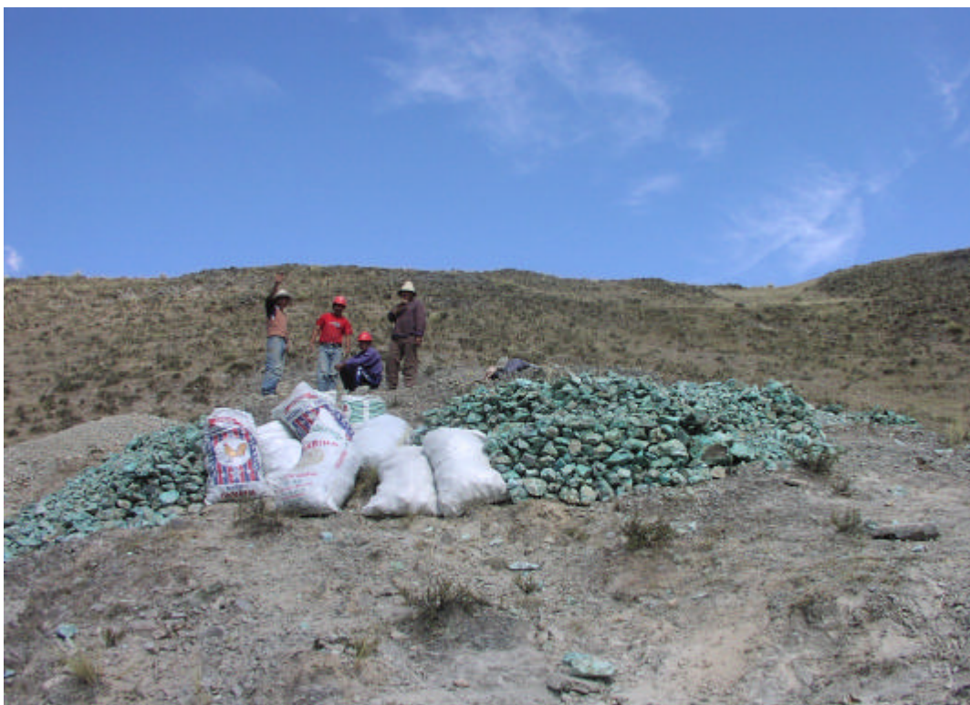
Foto 35.- Mineral de cobre con leyes que superan el 30% extraído de un yacimiento recientemente descubierto - Caychapampa.
