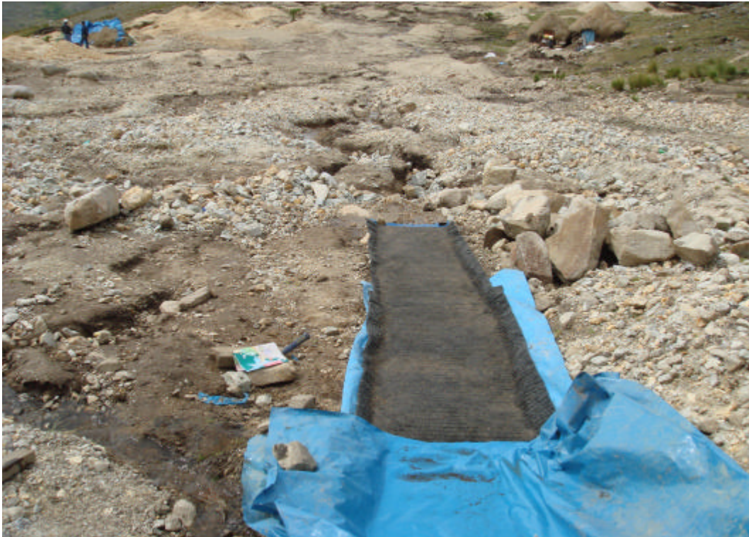
Foto 11.- Arreglos de método de explotación-beneficio, que consisten en canales con alfombra de baja pendiente - San Lucas (Progreso).
