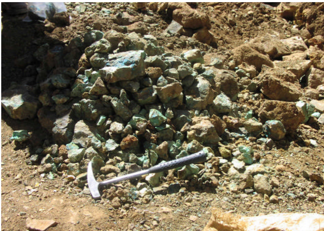
Foto 19.- Disposición de mineral de cobre, luego de la actividad de pallaqueo.
