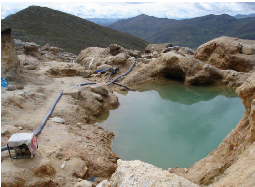
Foto 6.- Pequeña operación minera por el método de cielo abierto para la explotación de oro en depósito detrítico ubicado en Progreso, provincia de Grau.
