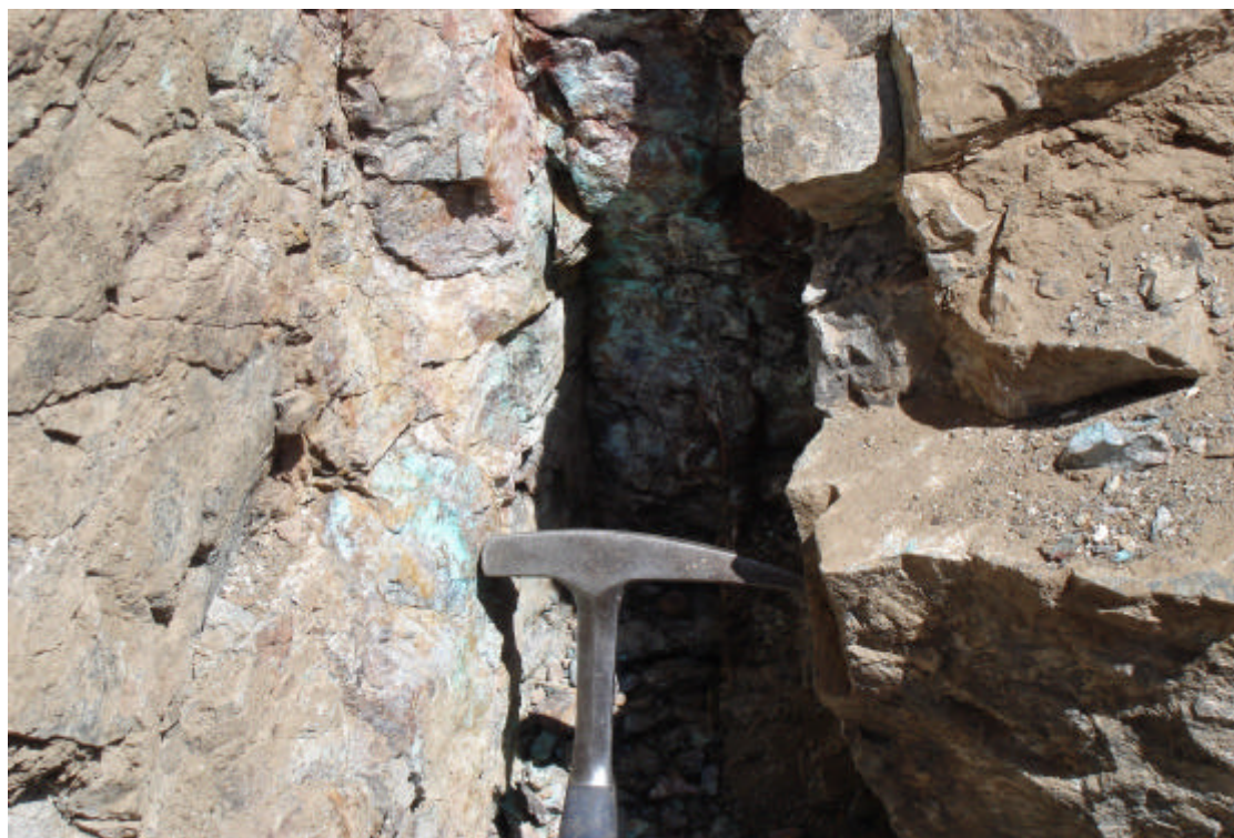
Foto 50.- Estructura mineralizada de cobre con buzamiento subvertical - Lúzbel.
