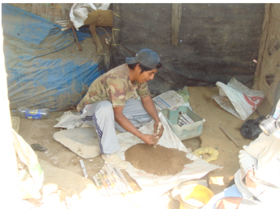
Foto 4.14 Minero artesanal en plena tarea de preparación de tacos para el cargado de taladros con dinamita - zona Lomada.
