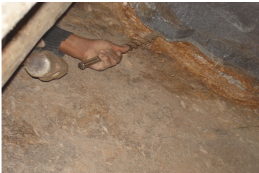
Foto 4.9 Veta de oro de 7 cm de potencia, con valores de 3 oz/TM de oro - zona Caracol.
