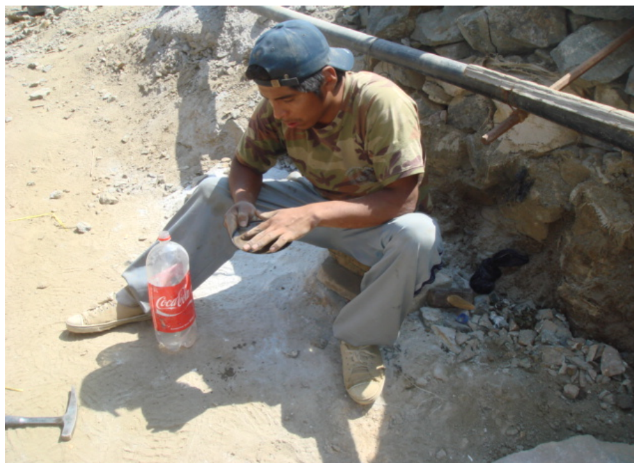
Foto 4.13 Minero artesanal con una mini batea, probando la concentración del mineral de oro, este mecanismo es regular para determinar la continuidad de los trabajos de explotación - zona Lomada.
