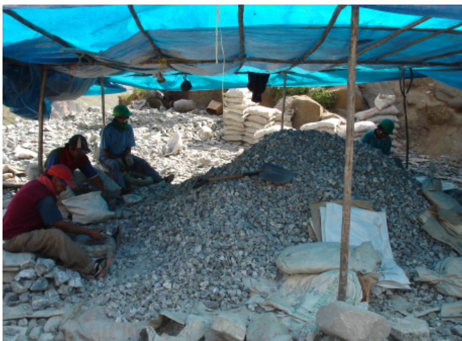
Foto 3.3 Reducción del tamaño del mineral con chancado manual. Se obtiene mineral de ½ pulgada-zona Lajas.
