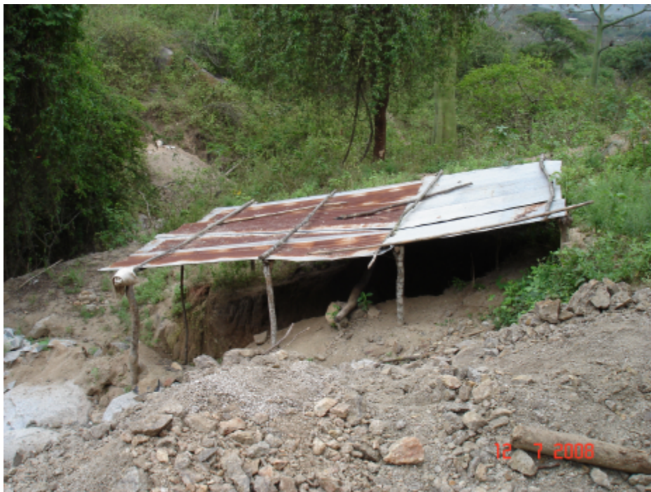
Foto 4.35 Instalación que protegen de las lluvias, el acceso a las labores de extracción (sector Jambur).
