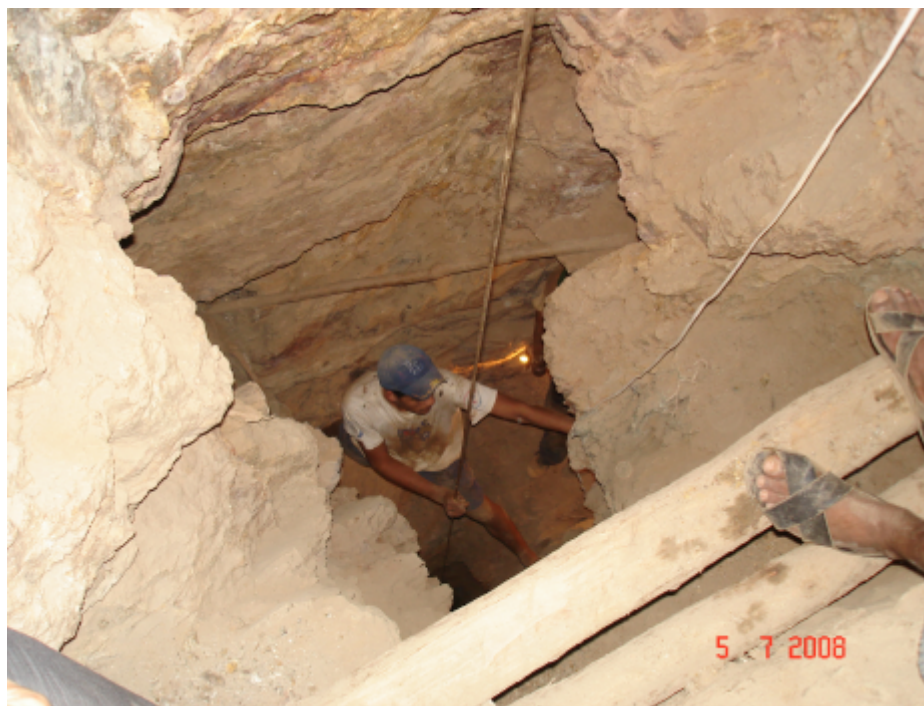
Foto 4.4 Pique de acceso y evacuación de 10 metros de profundidad, se aprecia la caja techo bastante definida como guía de la veta mineralizada en ambiente de intrusivos (sector Servilleta).
