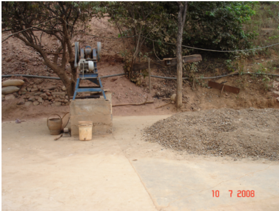
Foto 3.10 Chancadora de quijadas dispuesta en zona de preparación mecánica de mineral aurífero (sector Pampa Larga).
