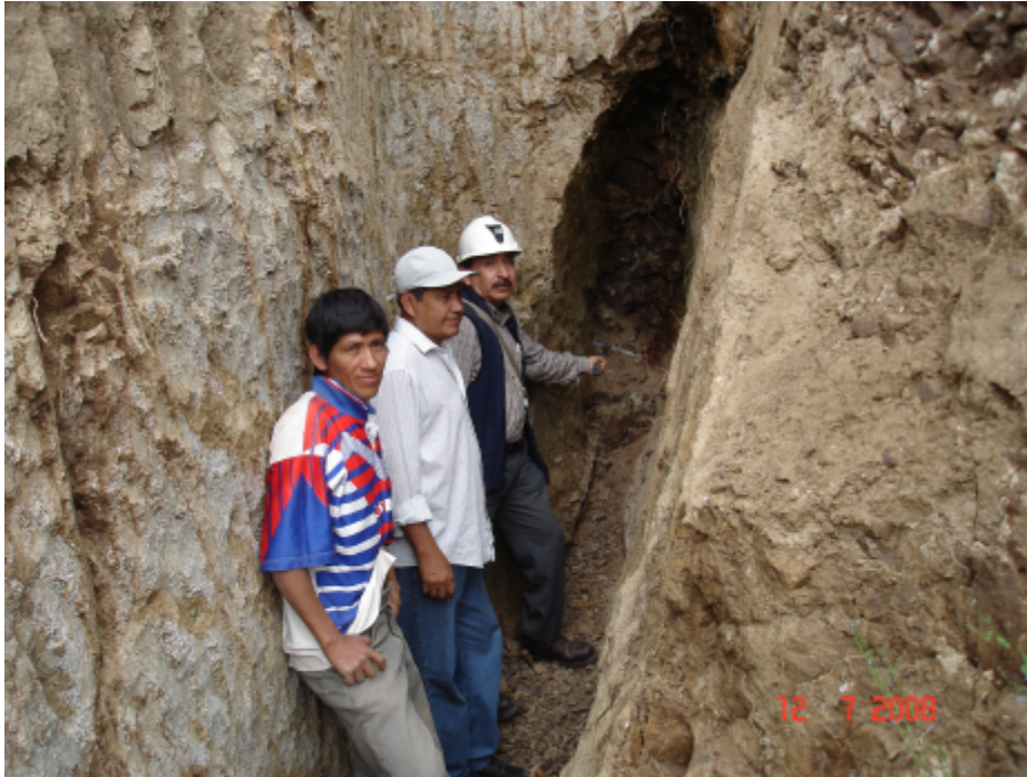
Foto 4.36 Extracción de mineral sobre veta subvertical, se aprecia el ambiente alterado que permite un desarrollo relativamente fácil (sector Jambur).
