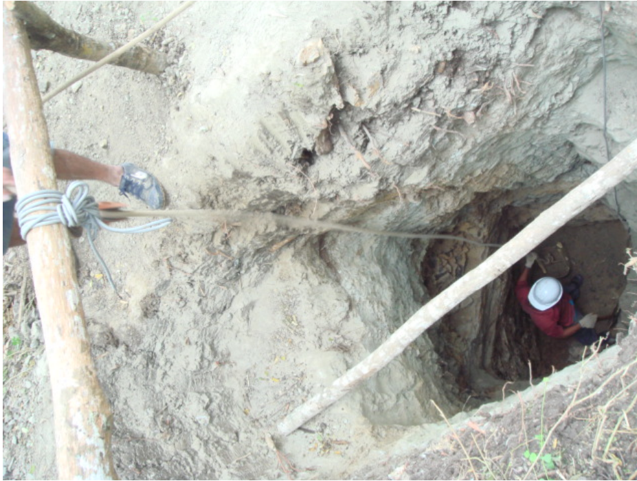
Foto 4.18 Pique de desarrollo con sección de 1,5 por 1,5 m, con profundidad de 10 m, en un ambiente bastante alterado (sector Roca Rajada).
