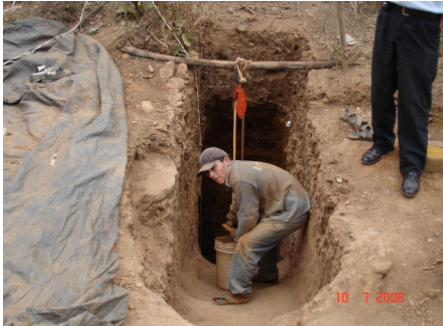
Foto 3.4 Pique para la extracción de mineral a través de polea y baldes de plástico (sector Alvarado, Bolsa del Diablo).
