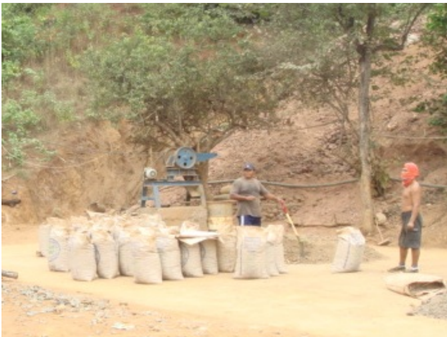
Foto 3.9 Preparación mecánica de mineral aurífero con chancadora de quijadas (sector Pampa Larga).
