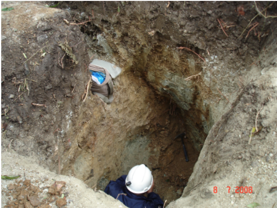
Foto 4.16 Cateos verticales, se profundizan de 2 a 5 m hasta alcanzar la estructura mineralizada en óxidos (sector Roca Rajada).
