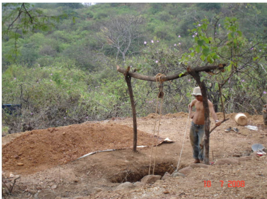
Foto 4.31 Pique de extracción y cancha de almacenamiento provisional de mineral de oro (sector Pampa Larga).
