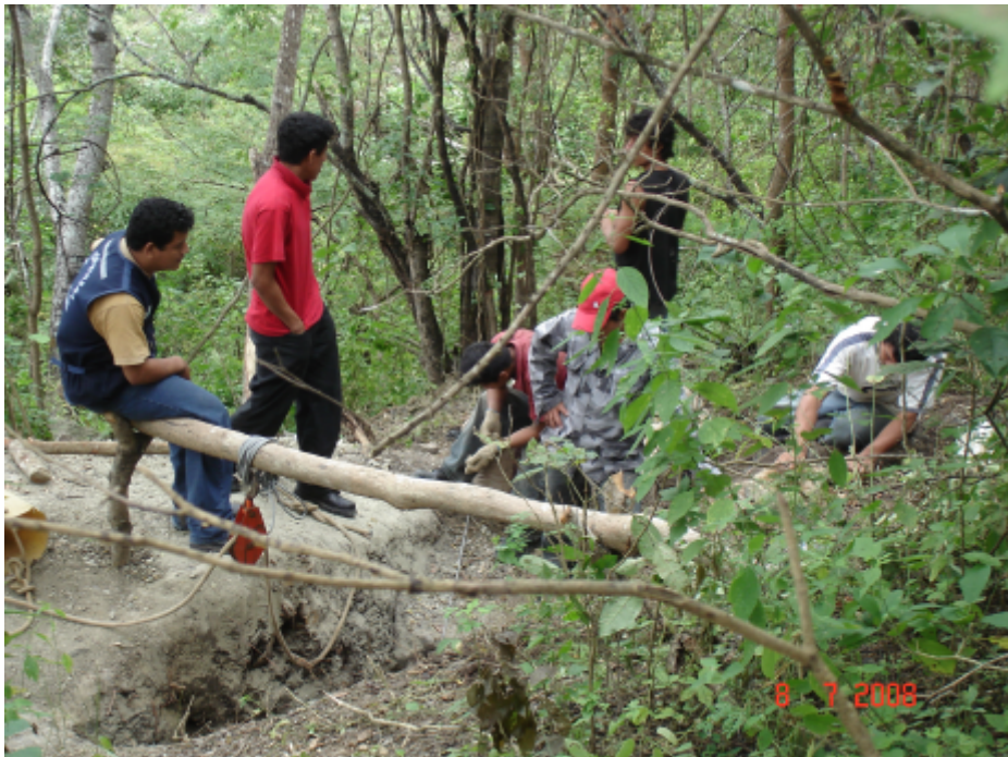
Foto 4.17 Instalaciones en actividades de cateo vertical. Se profundiza hasta 10 m para alcanzar la estructura mineralizada (sector Roca Rajada).
