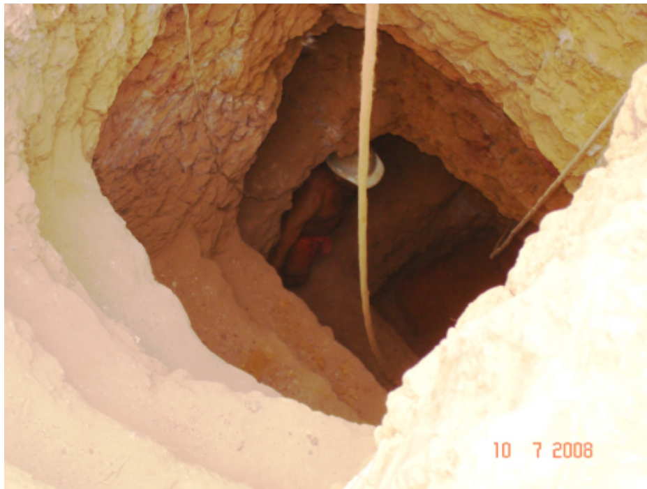
Foto 4.28 Pique de acceso y extracción de mineral, se aprecia el contexto alterado e inestable (sector Pampa Larga).
