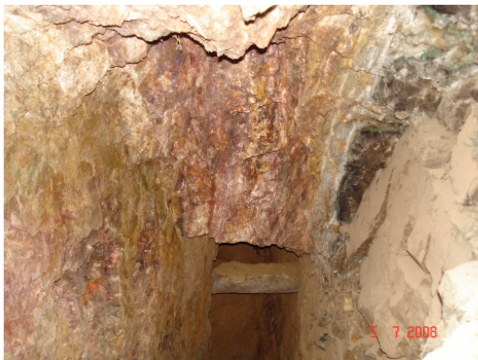
Foto 4.5 Veta sub vertical mineralizada más representativa de la labor La Española, en ambiente de óxidos, seguimiento horizontal, con cajas muy bien definidas (sector Servilleta).
