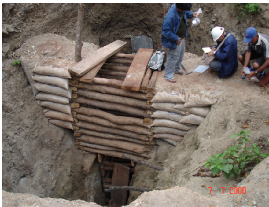
Foto 3.2 Zona mineralizada con alteración, es profundizada con cuadros de estabilización en posición vertical (sector Cuchicorral).
