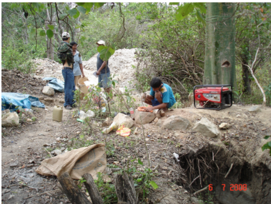
Foto 3.11 Reducción del tamaño del mineral con chancado manual. Se obtiene mineral de ½ pulgada (sector Servilleta)
