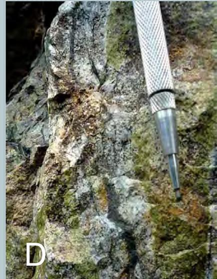
Prospecto Huallpachaca. A) y B) venillas de cuarzo con sulfuro diseminado. C) Venillas de cuarzo con una sutura central rellena con sulfuros. D. Venillas de cuarzo con magnetita.
