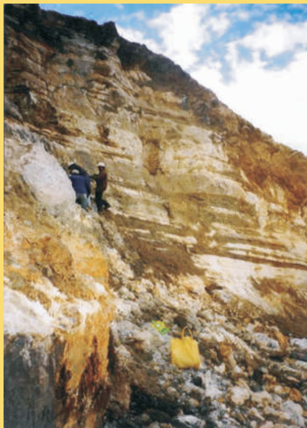
Tomando muestras del relave MR5 a 9 metros por debajo del borde
