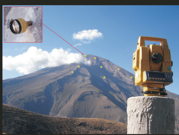
Figura 3. Estación total y prisma utilizados durante las mediciones electrónicas de distancias en el flanco oeste del volcán Misti.
