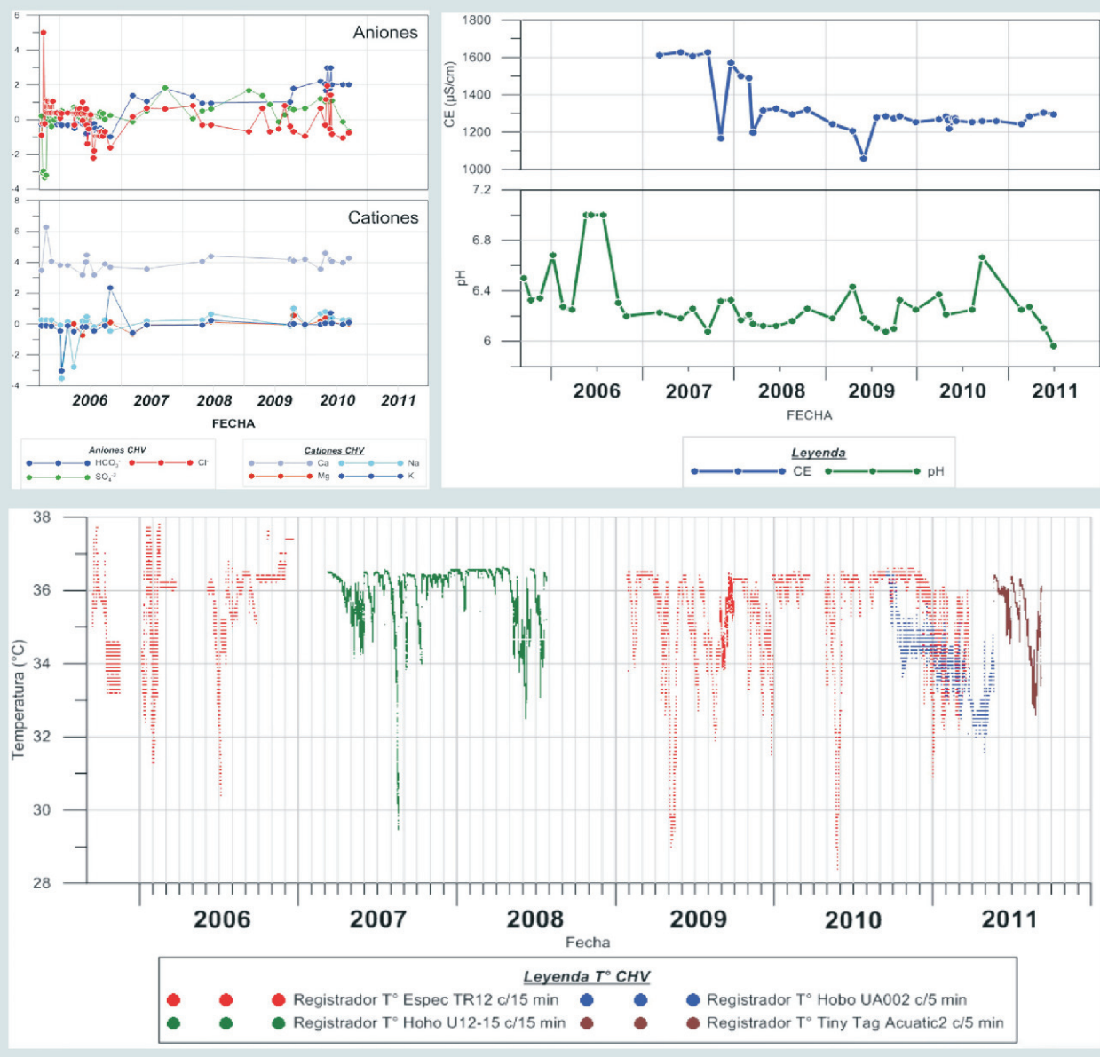
Figura 2. Resultados de la concentración química (iones) y parámetros fisicoquímicos (Conductividad Eléctrica, potencial de hidrógeno, temperatura) de la fuente Charcani V (CHV).
