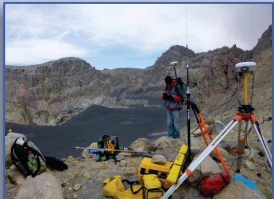
Personal del OVI realiza monitoreo geodésico con equipos GPS de alta precisión en el volcán Ubinas.
