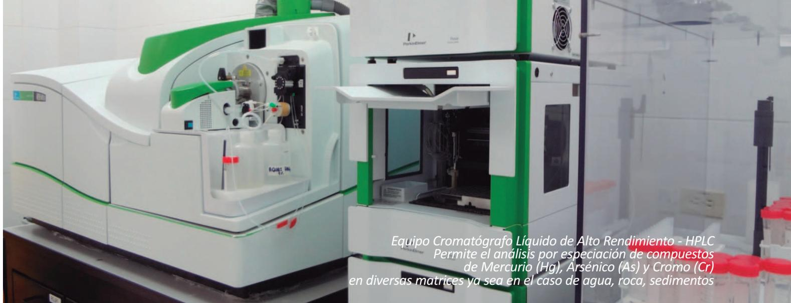
*Equipo Cromatógrafo Líquido de Alto Rendimiento - HPLC
