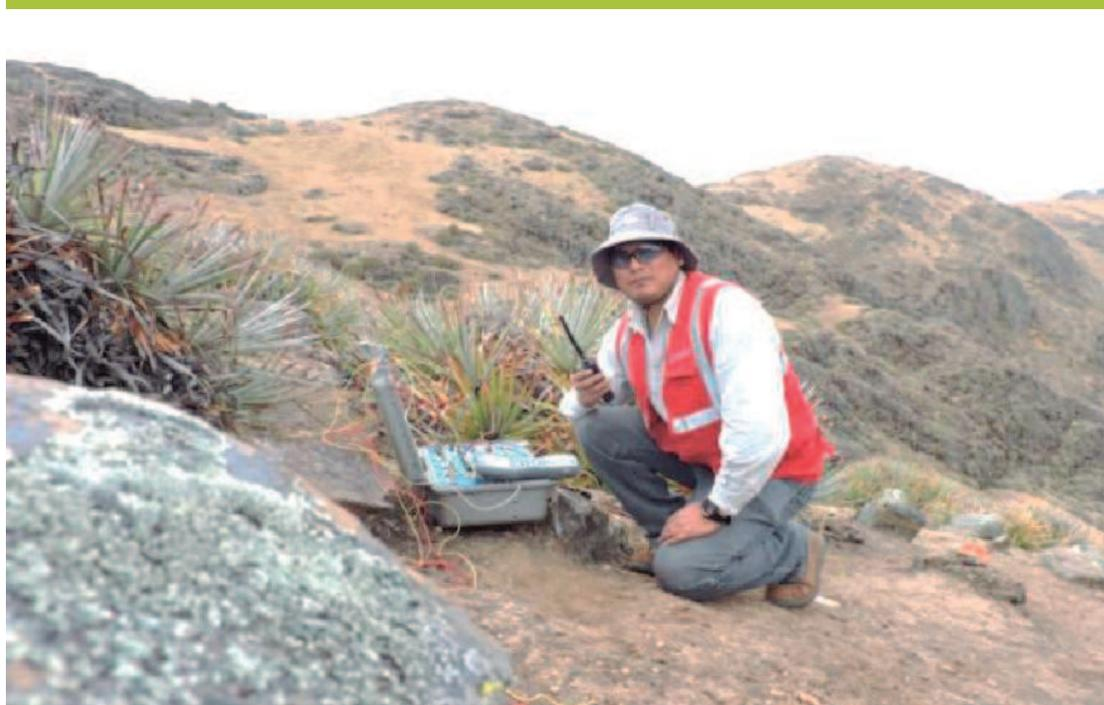
Personal geofísico realizando la adquisición de datos de polarización inducida operando un Receptor GDD de 32 canales, modelo GRx8-32 en el ANAP Antabamba Bloque 3, región Apurímac.
