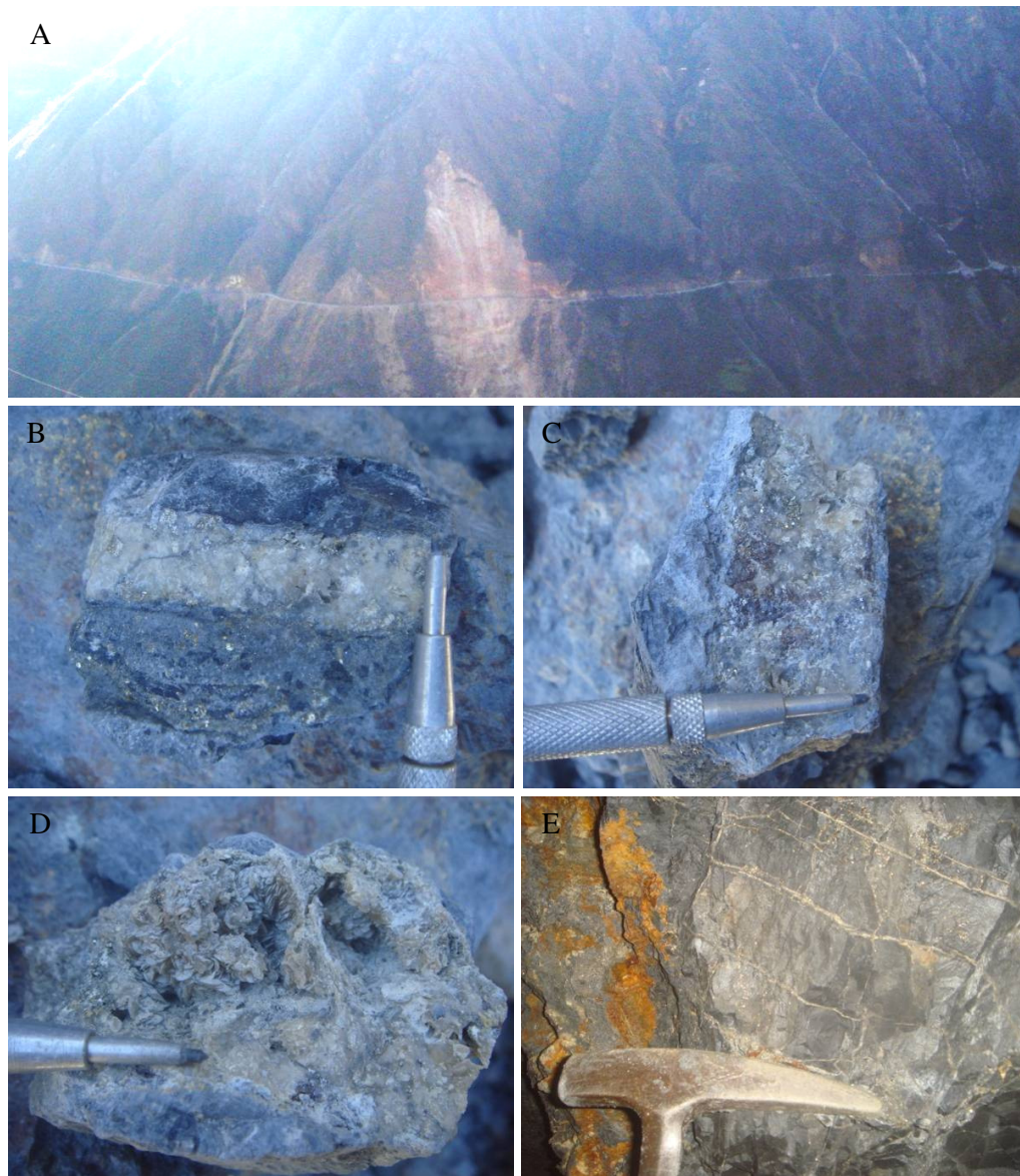
Figura 3.8.- (A) Vista panorámica de la unidad minera Socosani. (B y C) Veta de siderita-cuarzo- calcopirita-pirita-galena y esfalerita. (D) Detalle del hábito hojoso de la siderita. (E) Roca caja alterada con venillas de cuarzo-calcopirita-pirita.
