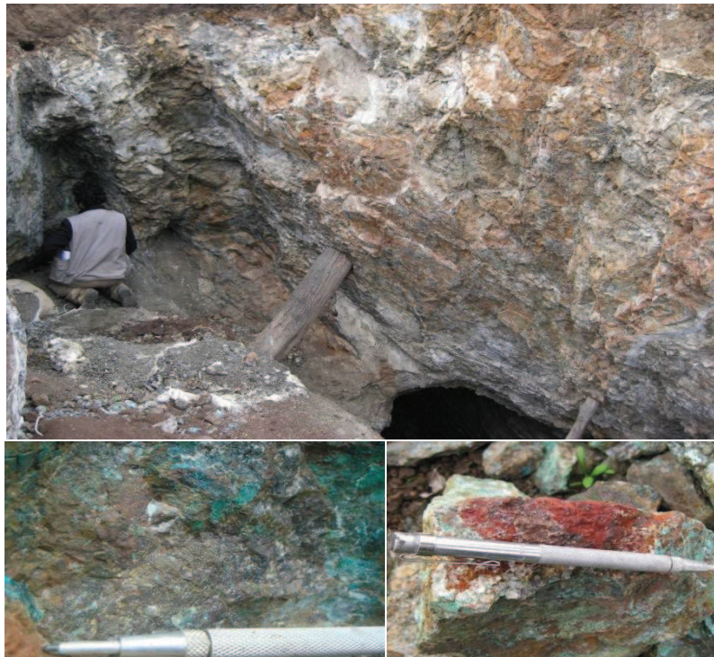
Figura 3.4.- Arriba: Labores artesanales que siguen la veta con óxidos de cobre con dirección E-O. Abajo: Minerales económicos de cobre, como malaquita-azurita y cuprita, extraídos de las labores.
