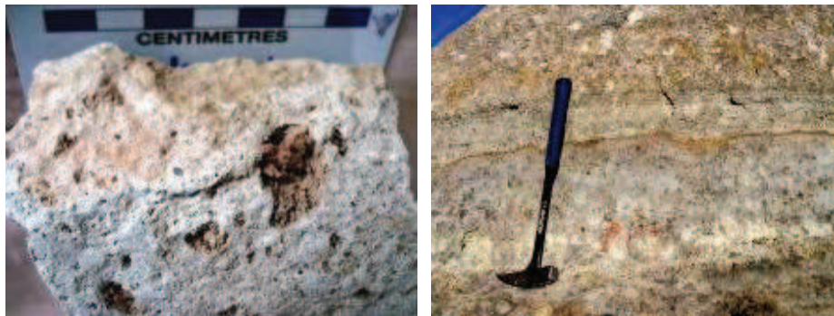
Figura 2.3.- Izquierda: Toba blanca, con presencia de líticos (pumita) oscuros, de diferentes tamaños (mm – cm). El contenido mineral es de biotita, cuarzo, plagioclasa (andesina). Derecha: Quebrada Añashuayco, tobas blancas con disyunción columnar infrayaciendo a tobas Salmón.
