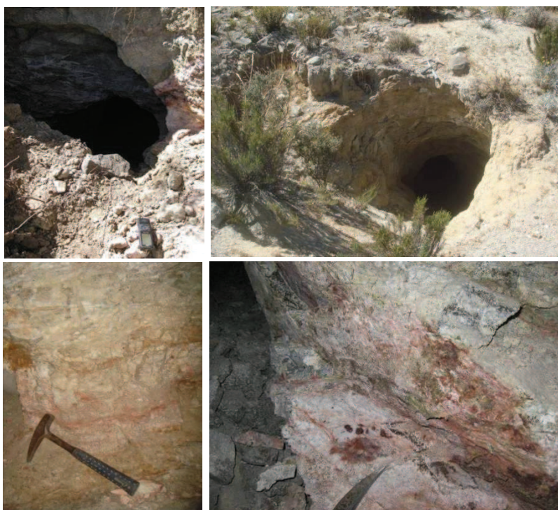
Figura 3.5.- Arriba: Labores mineras en forma de rampas y piques. Abajo derecha: Vetas de cuarzo-hematita con halo de feldespato potásico y epidota. Abajo izquierda: Vetas de 15 cm con cuarzo-especularita diseminada y epidota hospedada en intrusivo argilizado.
