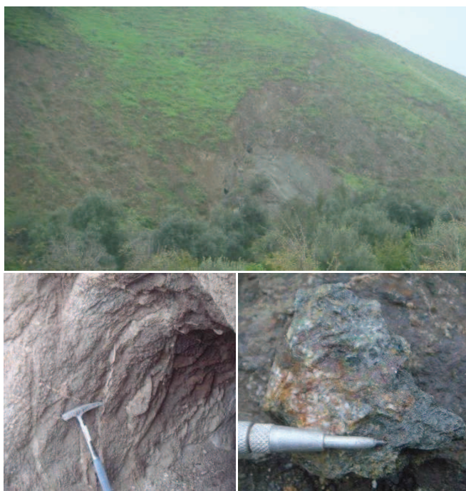
Figura 3.2.- Arriba: Labores mineras a lo largo de la veta NNE/82°NE con mineralización de magnetita con óxidos de cobre y cuarzo. Abajo: Cateo minero en alrededores con intrusivo alterado con venillas argilizadas (izquierda). Mineralización con magnetita-calcopirita-malaquita con óxidos de hierro.
