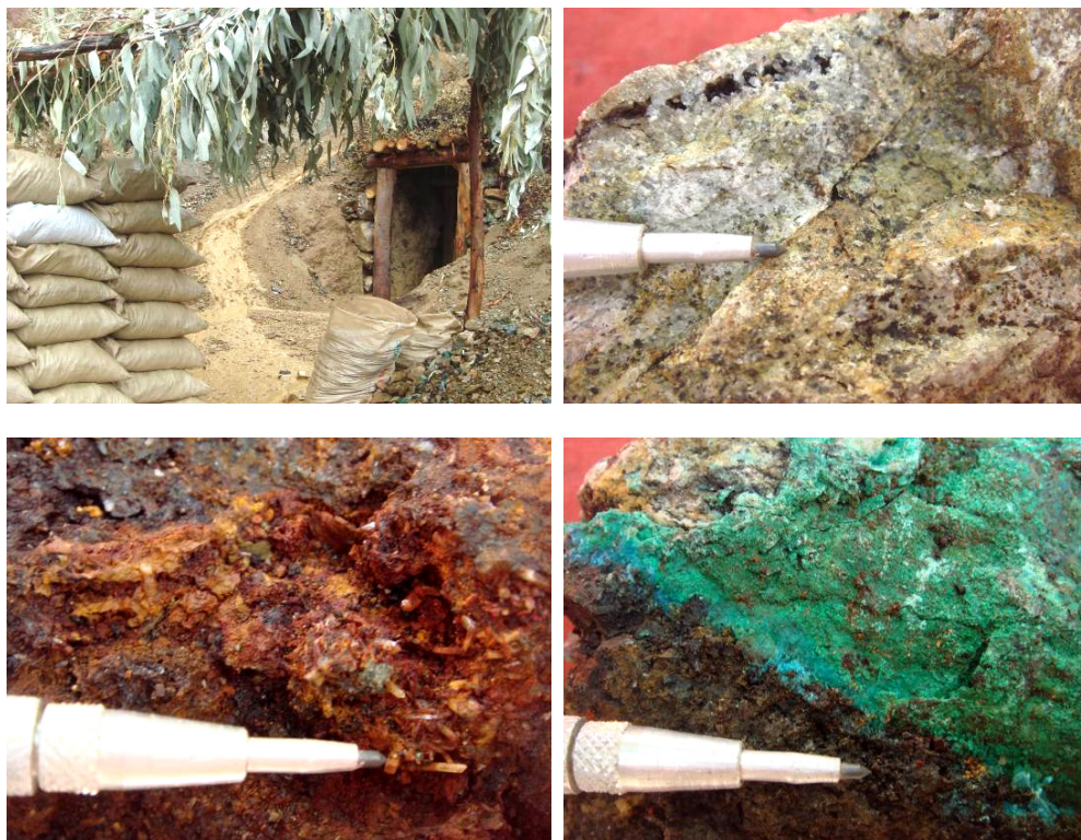
Figura 3.4.- Arriba, galería principal con mineral acopiado y detalle de la roca caja alterada. Abajo, óxidos de Fe con hematita, goethita y ganga de cuarzo, y óxidos de cobre con malaquita y neotocita.
