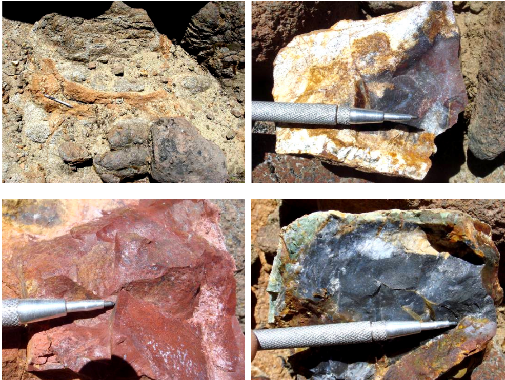
Figura 3.9.- Arriba, vetas de cuarzo amorfo y alteración argílica de la roca caja. Abajo, detalles del cuarzo amorfo rojo y gris con sulfuros.
