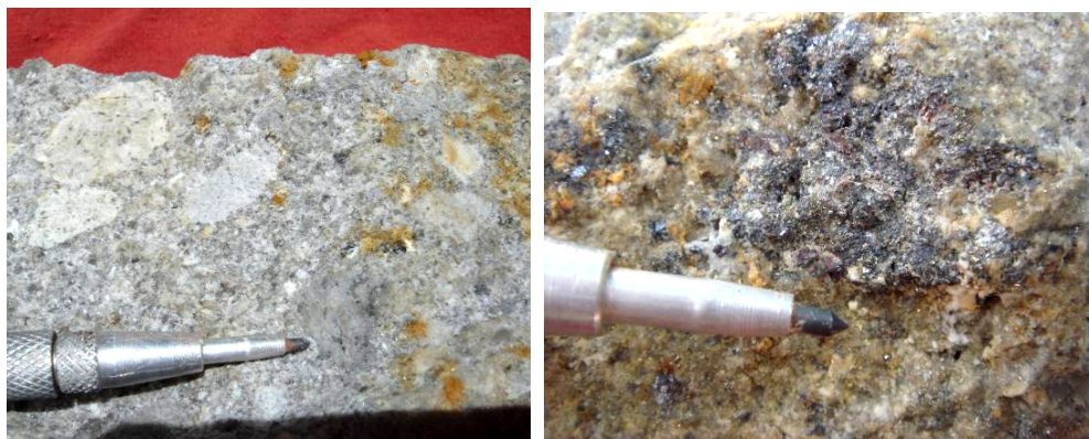
Figura 3.1.- Izquierda, muestra de toba con sulfuros diseminados y oxidados. Derecha, detalle de una vetilla con minerales de plata (proustita).
