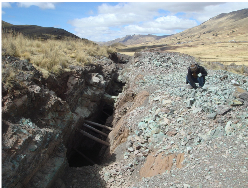
Figura N°3.4.- Manto de malaquita y azurita en las areniscas rojas de Fm Muñani (Cretáceo) en el depósito de Clara Luz (Langui).
