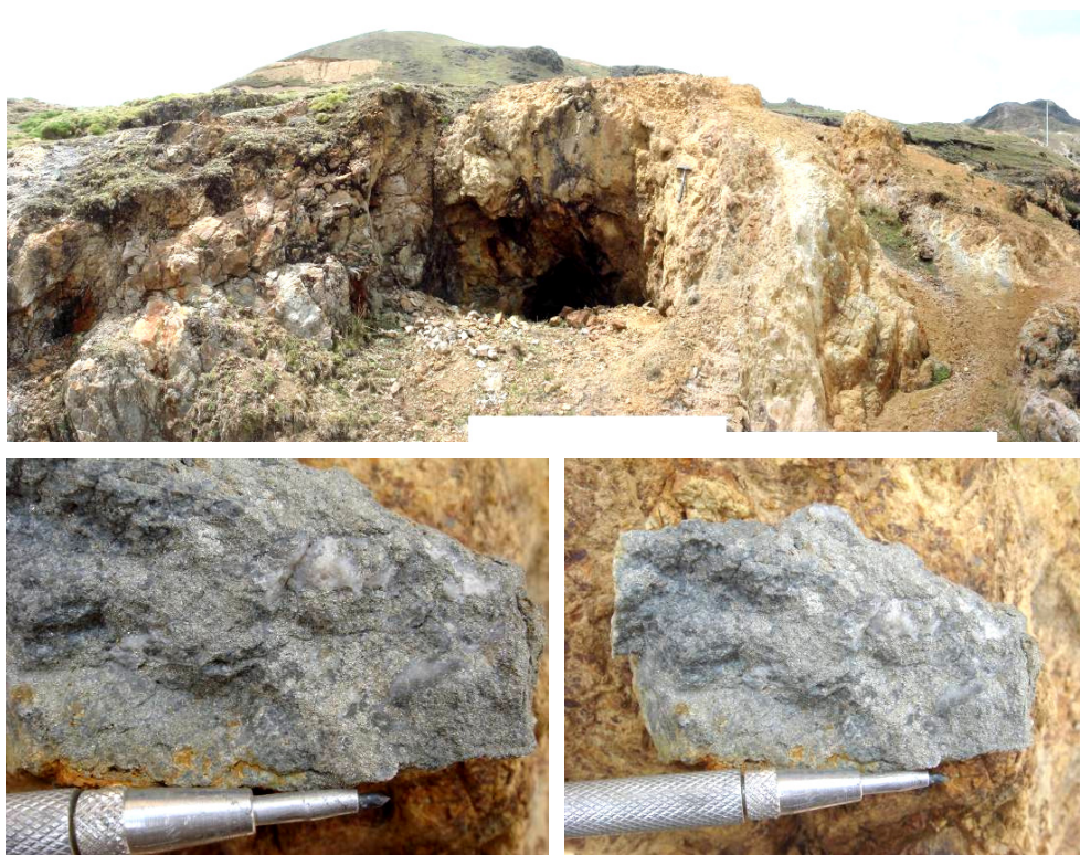
Figura 3.7.- Arriba, vista de la labor en la mina Tres Estrellas. Abajo, detalles de la mineralización con sulfuros diseminados y en cúmulos (pirita).
