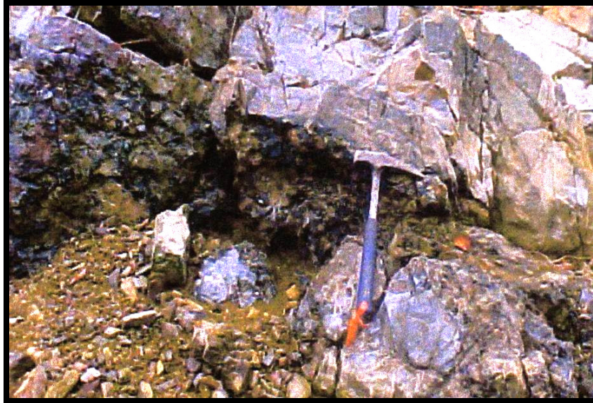
Figura 4.2.- Brecha suprayacente al stringer ore, contiene clastos de composición dacítica con alteración sericítica
