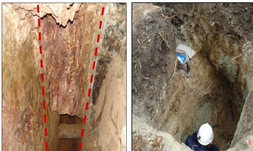
Figura 3.4.- Izquierda . Séctor Cerro servilleta presenta Valores de Au de hasta 270 g/t. Derecha . Séctor Cerro Servilleta .Valores anómalos de Cu >3000 ppm (No se descarta la existencia de pórfidos).
