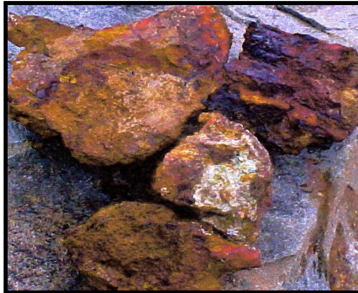
Figura 4.3.- Coluvio local de Gossan con contenidos jarosíticos, hematíticos y carbonatos de Cu extraído del afloramiento del Stringer Ore.
