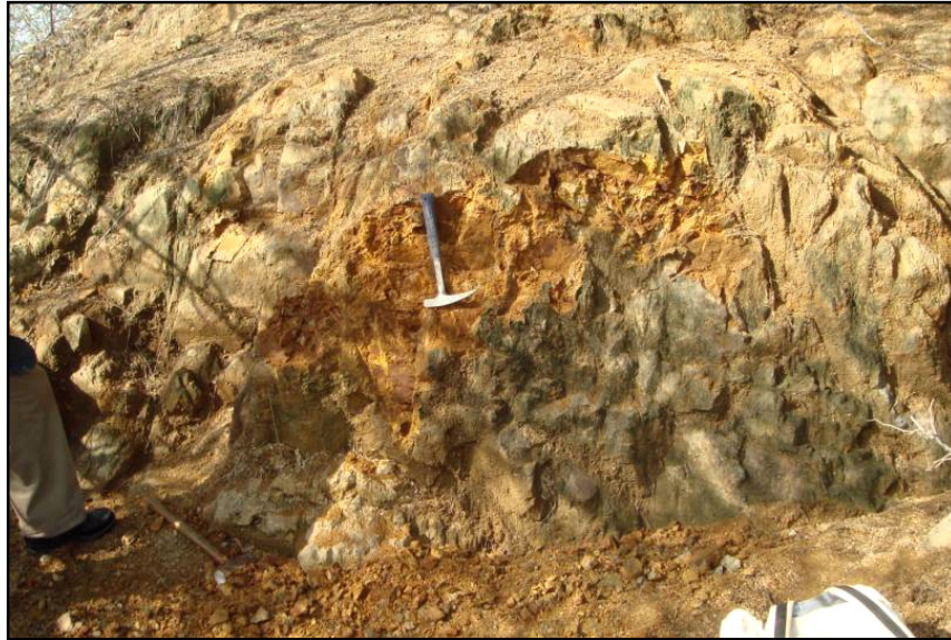
Figura 3.32.- Monzonita porfídica, con alteración sericíticas y presencia óxidos de hierro.
