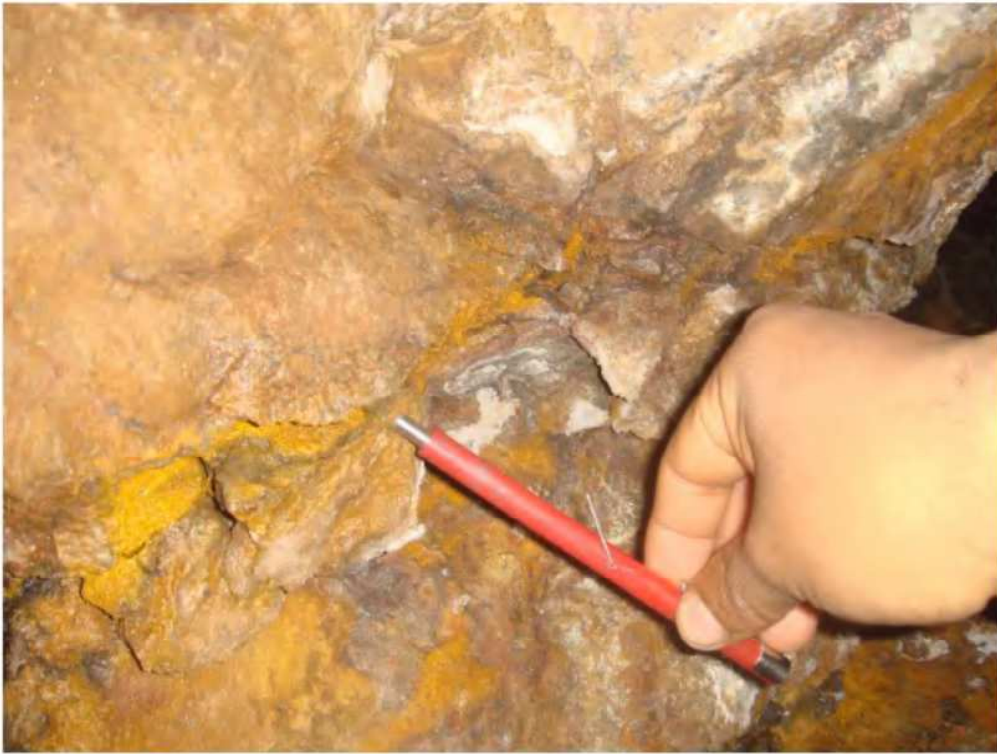
Foto 2.- Relleno de falla mineralizada de Mina Santa Rosa
