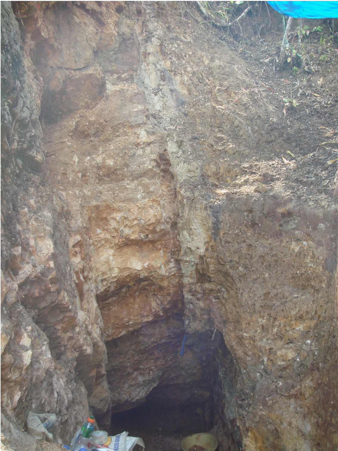
Foto 31.- Falla con panizo con mineralización en actual explotación. Tomaque-Mandinga.
