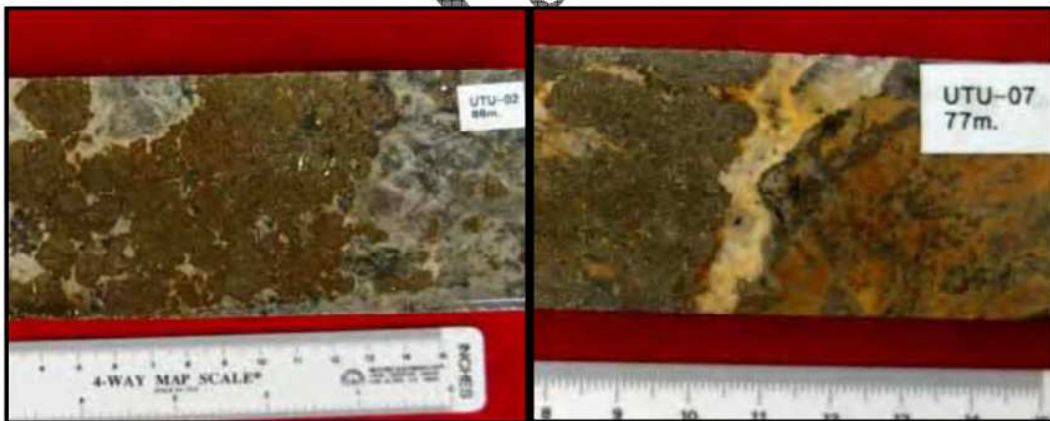
Fig. 3.1.- Muestras de sondaje mostrando estilos de mineralización en brecha intrusiva. (Bustamante, 2007).
