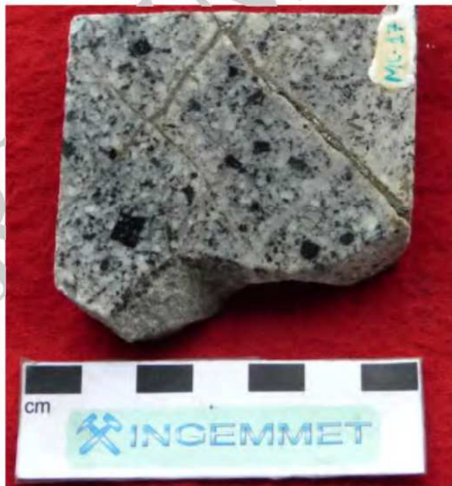
Fig.6 Roca ígnea del tipo monzonita de grano medio compuesta por feldespatos (plagioclasas), cuarzo, anfíboles y otros ferromagnesianos. Los anfíboles y otros ferromagnesianos están alterados a cloritas y magnetita. Textura predominante del tipo stock work con múltiples vetillas milimétricas de cuarzo cortadas por vetillas milimétricas de cuarzo-pirita con halos de sericita (vetilla tipo D).
