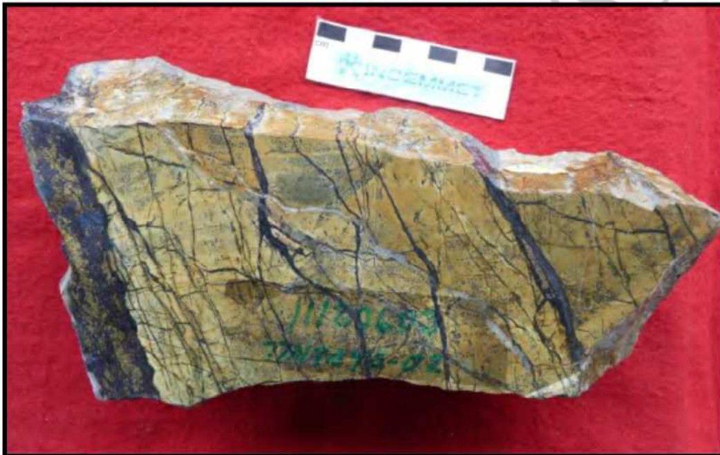
Roca Alterada a epidota y piroxenos cortada por venillas de calcopirita, bornita y calcocita.
