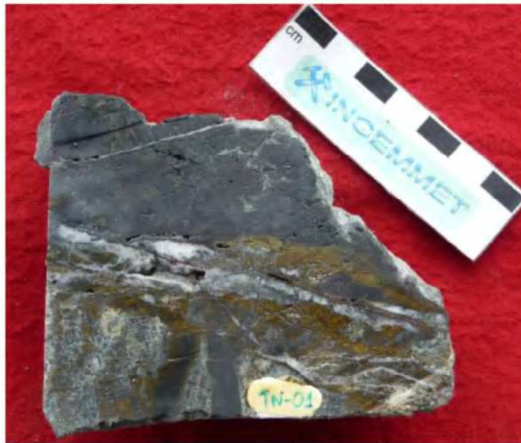
Fig.4 Cuerpo de magnetita con cloritas y calcita cortadas por una vetilla de aproximadamente 1,5cm de espesor compuesta por calcopirita y pirita (en las paredes) y calcita en el centro y rellenando otras fracturas.
