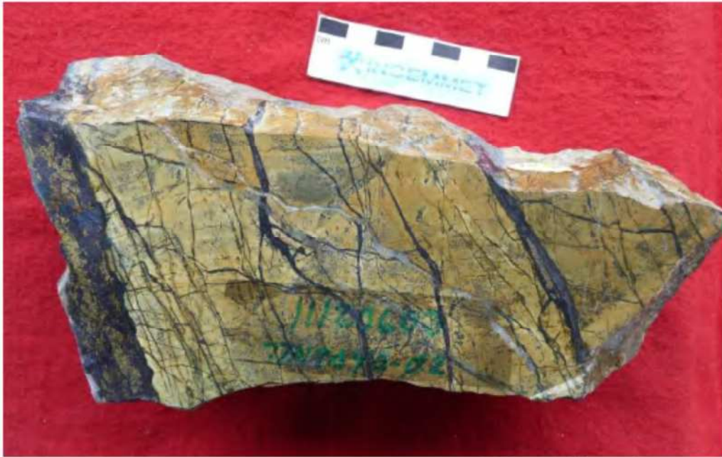
Fig.1: En la muestra tenemos la roca caja que está alterada a epidota y piroxenos que es cortada por múltiples vetillas milimétricas irregulares de calcopirita-bornita-calcocita en la parte superior de la muestra tenemos una vetilla de este tipo de aproximadamente 1,5cm de espesor, y a su vez estas vetillas son cortadas por vetillas de calcita y vetillas de cuarzo.
