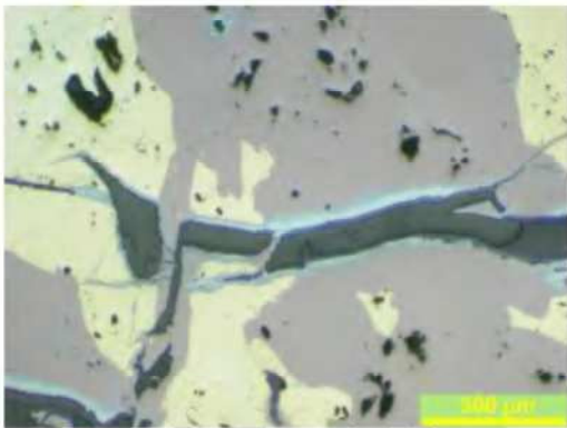
Fig.1a: En la fotografía se muestra una vetilla donde se observa calcopirita y bornita intercrecidas o como exsolucion, además se observa microfracturas que son rellenas por digenita como halos en la fractura, la que es rellanada por ganga
