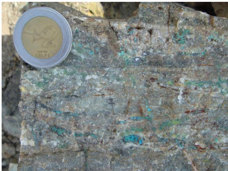
**Figura 3. Veta de cuarzo-galena, con vetillas de calcita y óxidos de cobre.**
